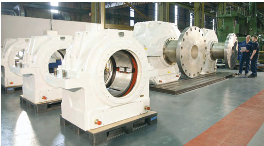
شکل ۲۴- یاتاقان‌های مورد استفاده جهت تکیه‌گاه محور پروانه
