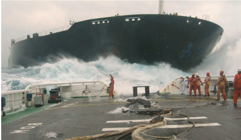
شکل ۵- پاره شدن طناب یدک‌کشی کشتی بر اثر نیروهای حاصل از امواج اقیانوس
