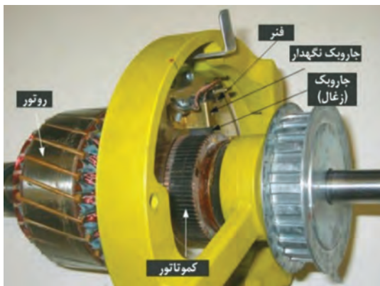
شکل ۵- جاروبک و جاروبک نگهدار
