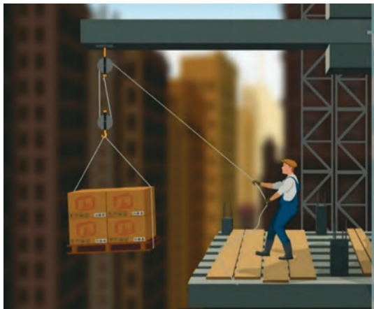
شکل ۲۶- ترکیب دو قرقه برای افزایش بهره مکانیکی
