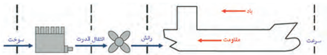
شکل ۱۵- نحوه انتقال قدرت از موتور به شناور جهت رانش شناور
