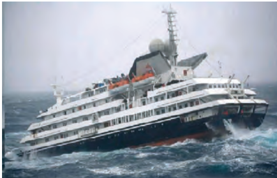
شکل ۸- شناوری که حالت Slamming برای آن اتفاق افتاده
