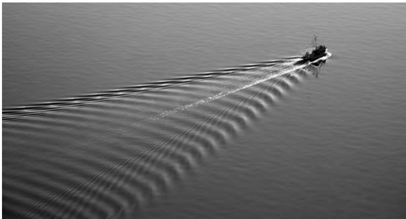
شکل ۴- تشکیل امواج بر اثر حرکت شناور
