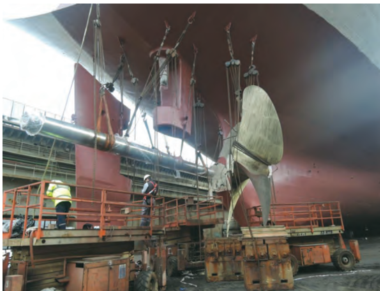
شکل ۲۰- طریقه خارج سازی محورهای پروانه در نوع معمولی
