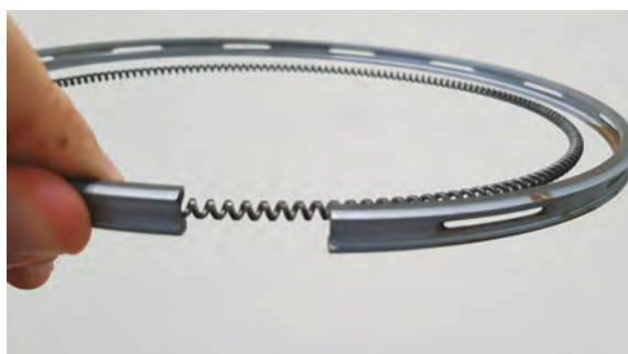
شکل ۱۴- رینگ پیستون
