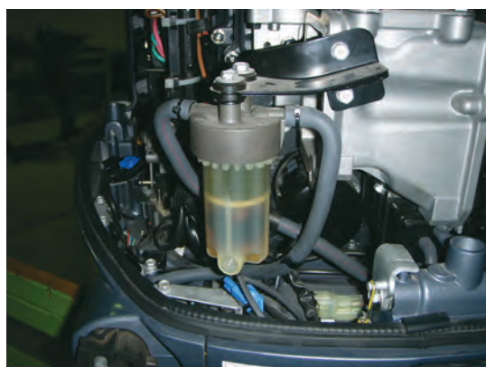
شکل ۴- پالایه اولیه سوخت
