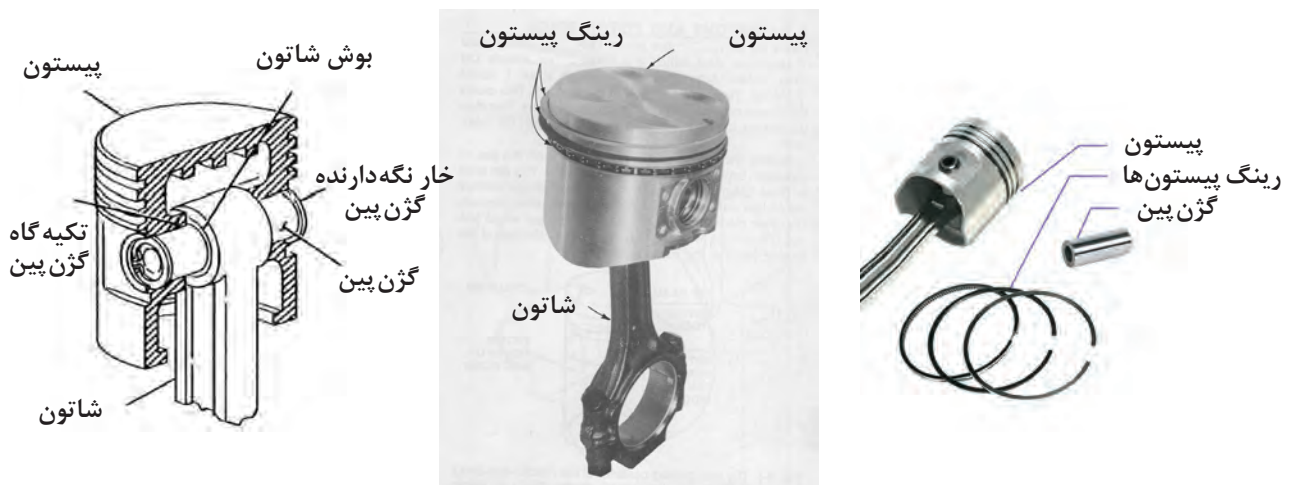
شکل ۲- پیستون و قطعات همراه آن
