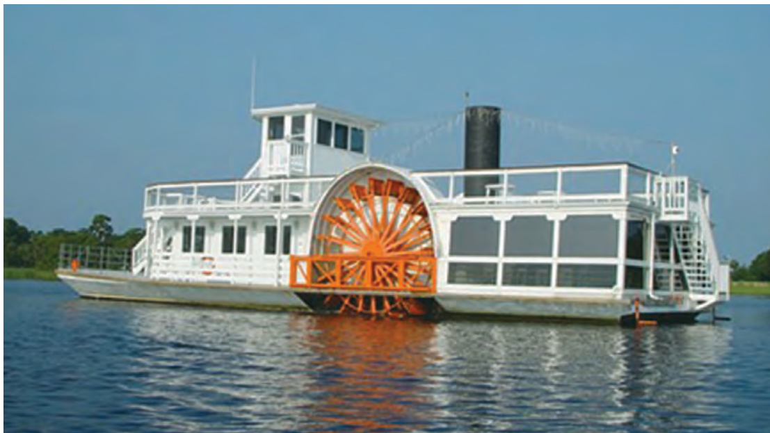
شکل ۱- سامانه پیشران چرخ پدالی
