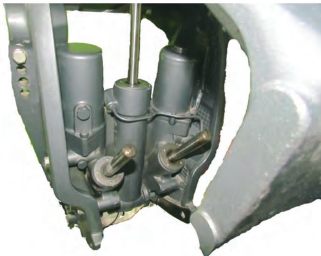
شکل ۳۷- سامانه جک هیدرولیکی
