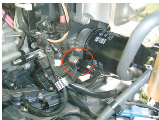
شکل ۲۱- حسگر فشار روغن
