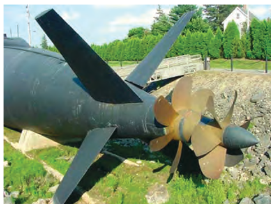
شکل ۸- پروانه های عکس چرخنده
