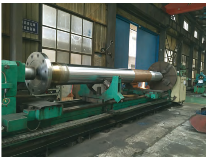
شکل ۹- محور پروانه در کارگاه جهت ماشین‌کاری
