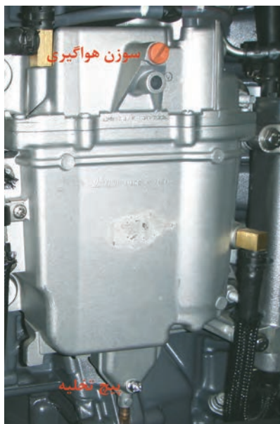
شکل ۷- مخزن تفکیک بخار
