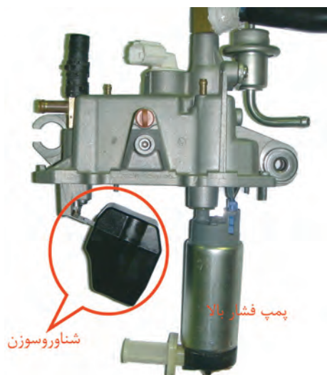
شکل ۸- مجموعه داخل مخزن تفکیک بخار
