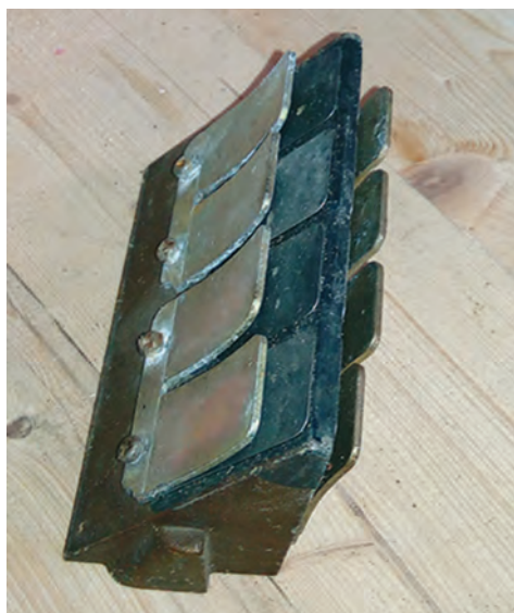
شکل ۴۴- سوپاپ‌های یک‌طرفه
