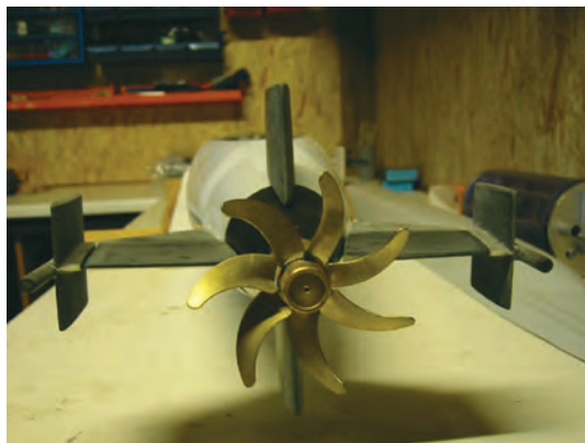
شکل ۶- پروانه گام ثابت
