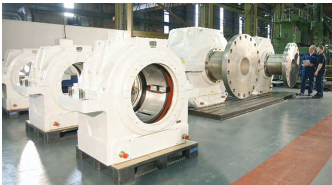
شکل ۲۴- یاتاقان‌های مورد استفاده جهت تکیه‌گاه محور پروانه
