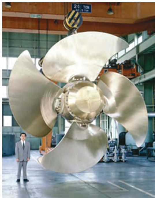
شکل ۷- پروانه گام متغیر
