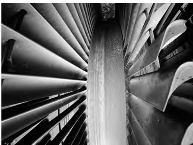
شکل ۸- میله‌های عبور کننده از داخل پره‌ها
