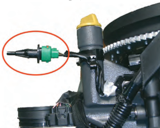
شکل ۱۸- حسگر دمای هوای ورودی
