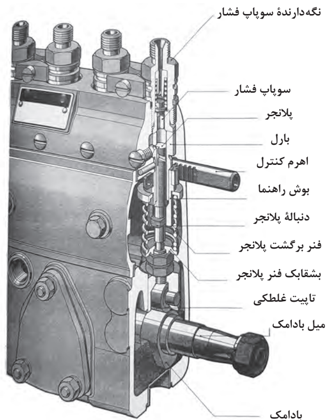
شکل ۳۱- پمپ انژکتور نوع جرک
