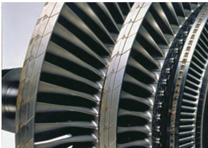
شکل ۷- محل اتصال پره‌ها با چرخ
