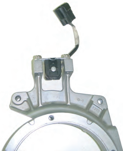
شکل ۱۶- حسگر موقعیت میل لنگ
