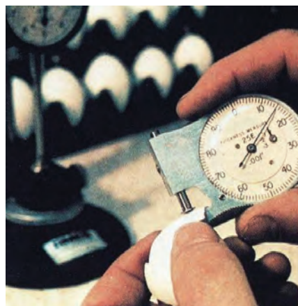
تصویر ۲۵-۱- اندازه‌گیری ضخامت پوسته با میکرومتر
