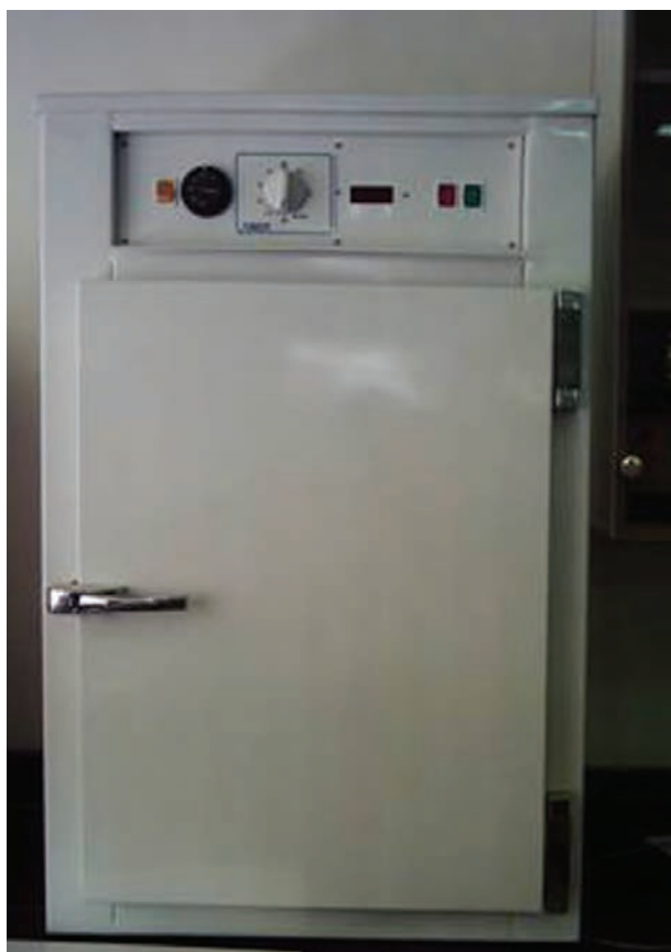
شکل ۱-۳- دستگاه خشک کن (اُون)
