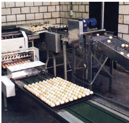
تصویر ۵-۴- انتقال تخم مرغ به شانه‌ی جوجه کشی با روش تمام خودکار
