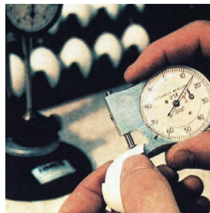
تصویر ۲۵-۱- اندازه‌گیری ضخامت پوسته با میکرومتر
