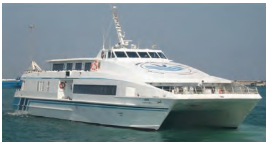
شکل ۱۵- یک شناور کاتاماران با بدنه آلومینیومی
