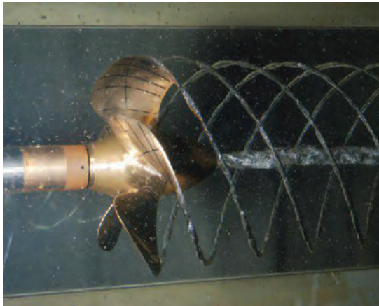
شکل ۲- نیروی رانشی پروانه
