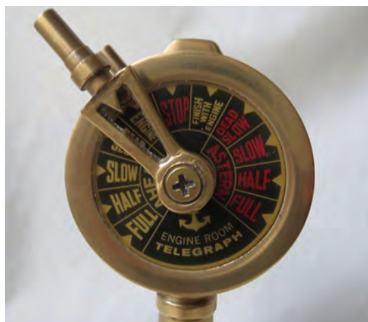
شکل ۳۹- تلگراف و محل آن در اتاق کنترل موتورخانه.
