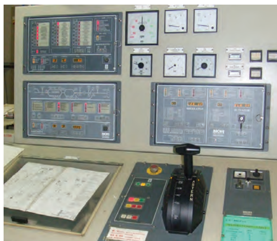
شکل ۳۹- تلگراف و محل آن در اتاق کنترل موتورخانه.
