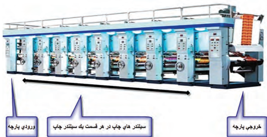
شکل ۸- نمای عملکرد ماشین چاپ غلتکی افقی
