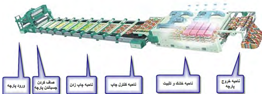
شکل ۶- نمای عملکرد ماشین اسکرین تخت اتوماتیک
