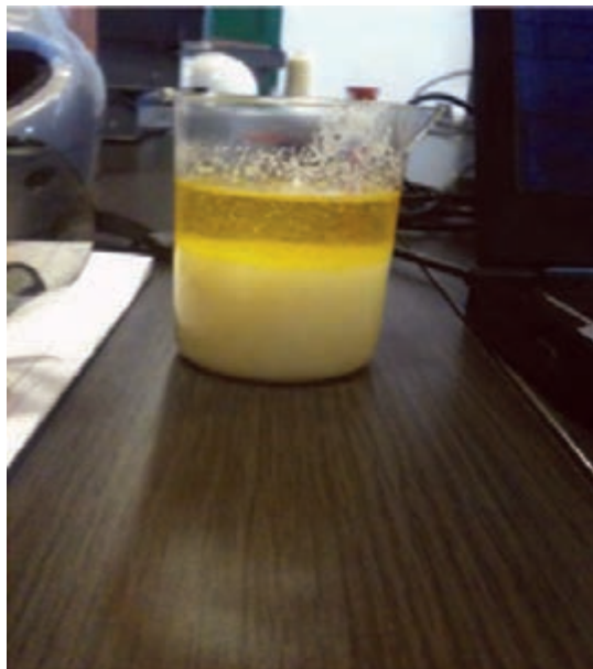
شکل ۹- تفکیک فاز مایع و جامد روغن
