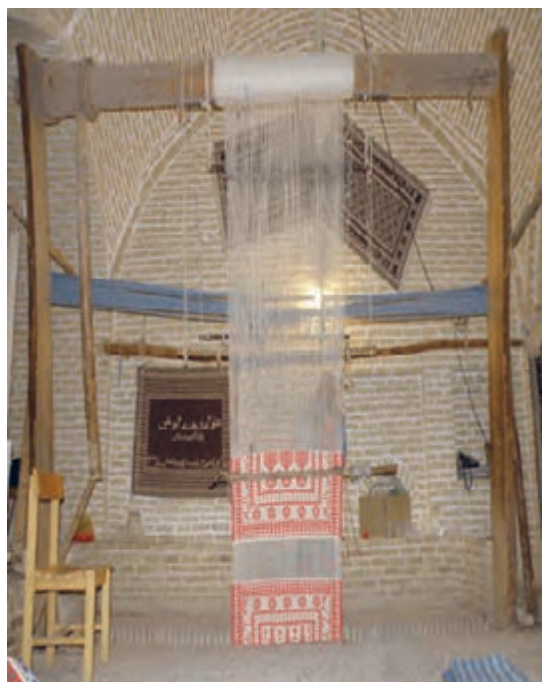
شکل ۲۲-۱ دار چوبی و ثابت برای بافت زیلو
