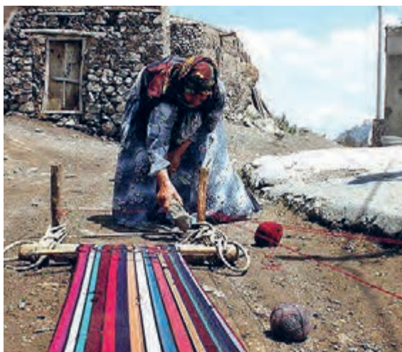
شکل ۳۶-۱ دستگاه چوبی جاجیم بافی (افقی)
