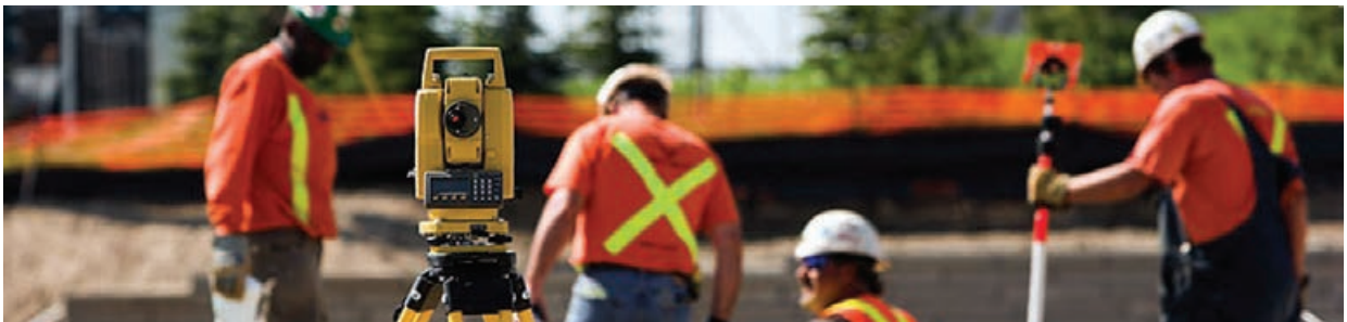
شکل ۴-۱. پیاده کردن با دوربین نقشه برداری
