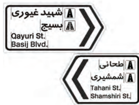
شکل ۲۵ - نمونه‌هایی از تابلوهای هدایت مسیر / خروجی (پرچمی)
