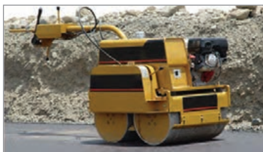
شکل ۴۱- غلتک دستی برای تراکم آسفالت
