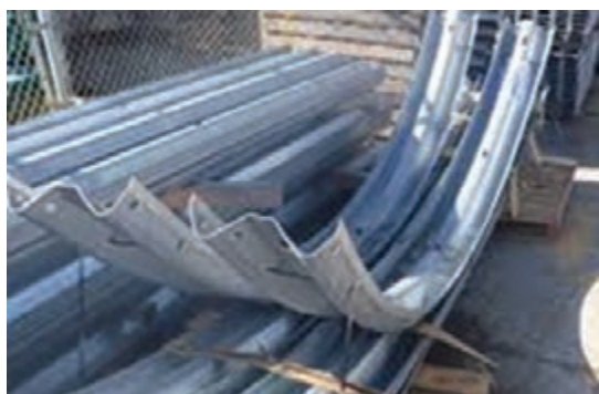
شکل ۶۶- سپری محدب گاردریل
