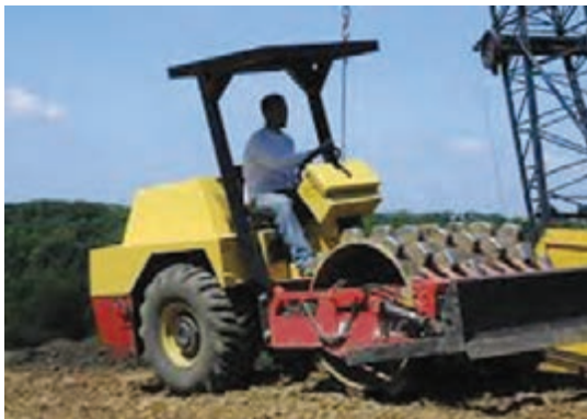
شکل ۱۱- غلتک از نوع پاچه بزی
