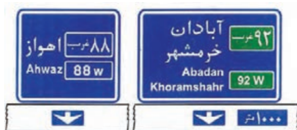
شکل ۲۲ - نمونه‌هایی از تابلوهای هدایت مسیر / پیش‌آگاهی جانبی
