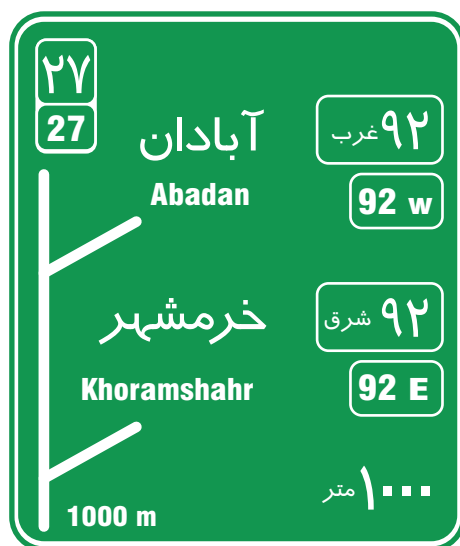
شکل ۲۱ - نمونه‌ای از تابلوهای هدایت مسیر از نوع پیش‌آگاهی
