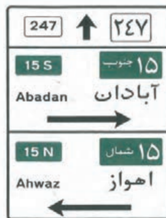
شکل ۳۱- نمونه تابلوی استک تاپ
