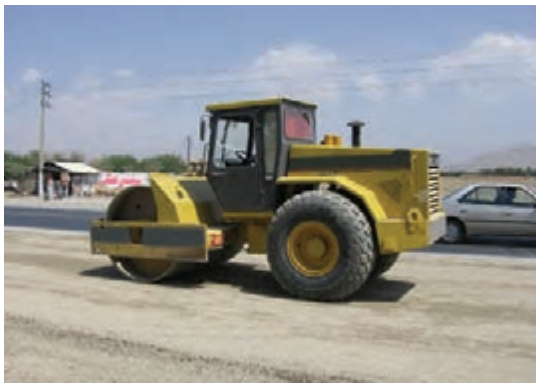
شکل ۱۰- غلتک از نوع ارتعاشی
