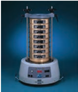
شکل ۸- دستگاه شیکر یا لرزاننده
