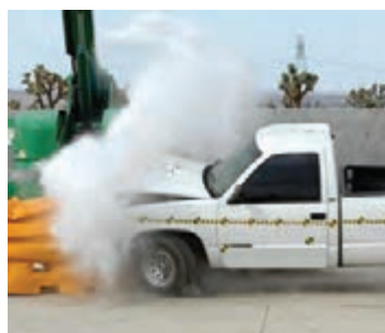
شکل ۱۲- تخریب ضربه‌گیرهای وزنی بشکه‌ای بعد از برخورد
