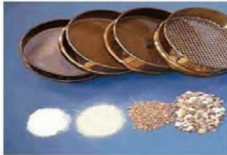
شکل ۷- سری الک های استاندارد دانه بندی خاک
