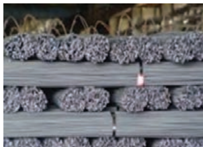
شکل ۱۸- میلگرد شاخه ای (۱۲ متری)
