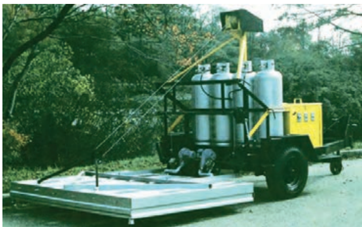
شکل ۴۷ - تجهیزات صفحه گرمکن
