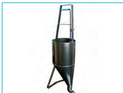
شکل ۳۲- نمونه‌ای از قیف مورد استفاده برای پر کردن مواد درزگیر سرد درون ترک
