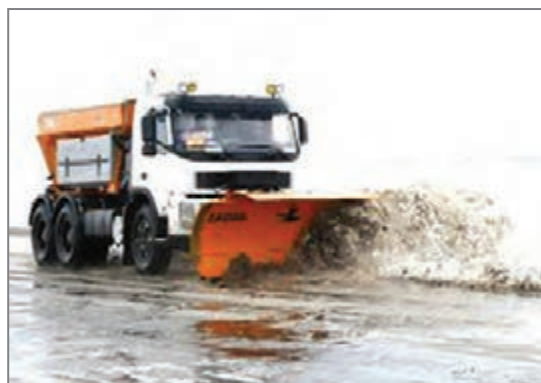
شکل ۱۴- کامیون مجهز شده به تجهیزات برف‌روبی
