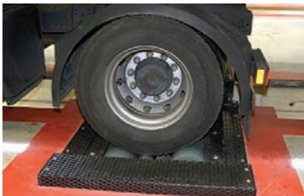
شکل ۲- انجام تست ترمز در سالن معاینه فنی وسایل نقلیه
