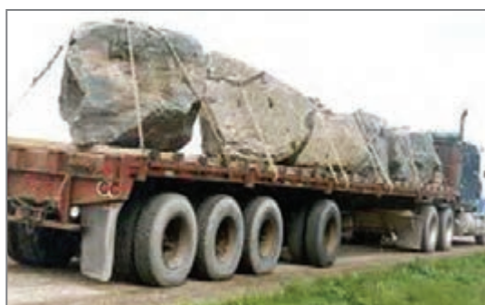
شکل ۱۶- نمونه‌ای از مهار صحیح سنگ‌ها
