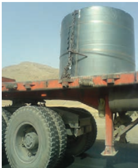
شکل ۳۷- نمونه‌ای از مهار نادرست رل فلزی تنها با یک زنجیر
