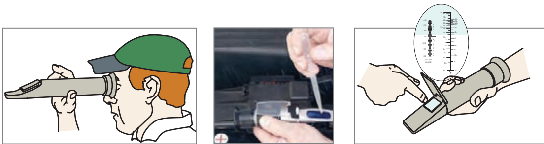
شکل ۱۸- اندازه گیری نقطه انجماد آب سیستم خنک کاری
