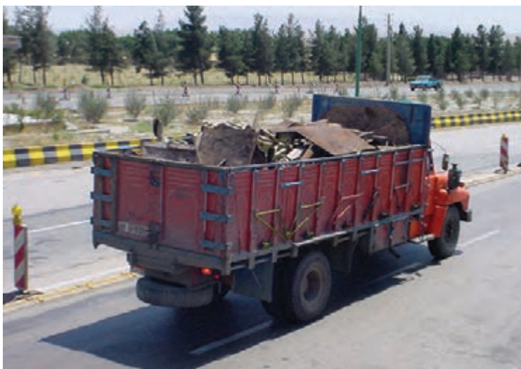
شکل ۵۷- حمل آهن قراضه بدون استفاده از پوشش مناسب
