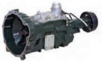
شکل ۲۶- نمای یک گیربکس نارگان جاده ای
