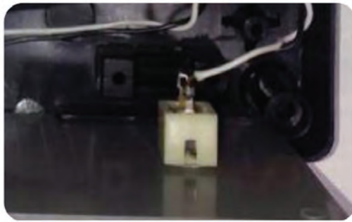
شکل ۱۷-۵- استفاده از ترمینال بلندگو در پروژه (پشت جعبه)
