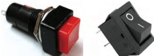
شکل ۴-۹۳- کلید قطع و وصل مدار
