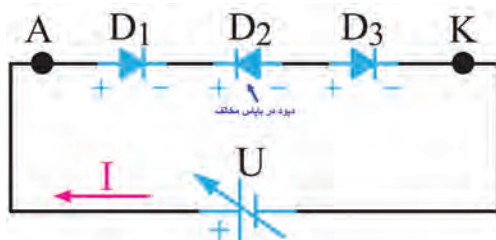
شکل ۷-۴ دیود چهار لایه در بایاس موافق
