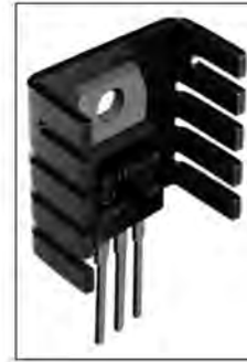
شکل ۷-۶۸ ترایاک متصل شده به گرماگیر
