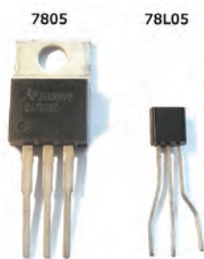
شکل ۲-۲- دو نوع بسته‌بندی TO۹۲ و TO۲۲۰
