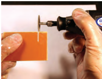
شکل ۸-۳- بریدن فیبر با مینی‌فرز
