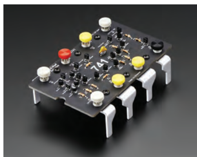
شکل ۴-۵۴- مدار داخلی آی سی ۷۴۱ با قطعات مجزا
