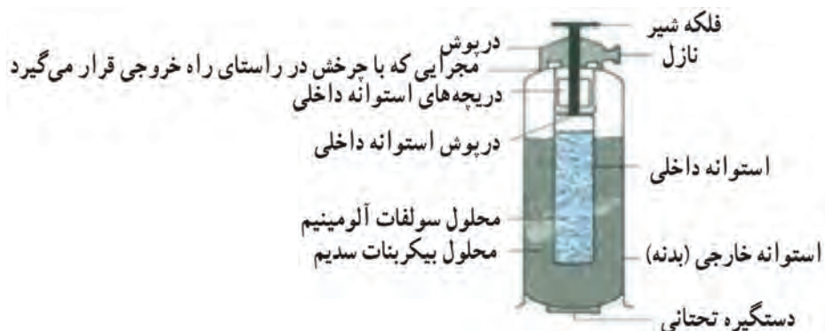
شکل ۷-۳ خاموش کننده دستی حاوی پودر آتش‌نشانی
