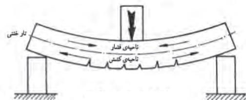
شکل ۱۴-۱ - تیر بتنی پس از بارگذاری ▲
