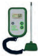
دستگاه اندازه‌گیری pH، حاصلخیزی و دمای خاک
