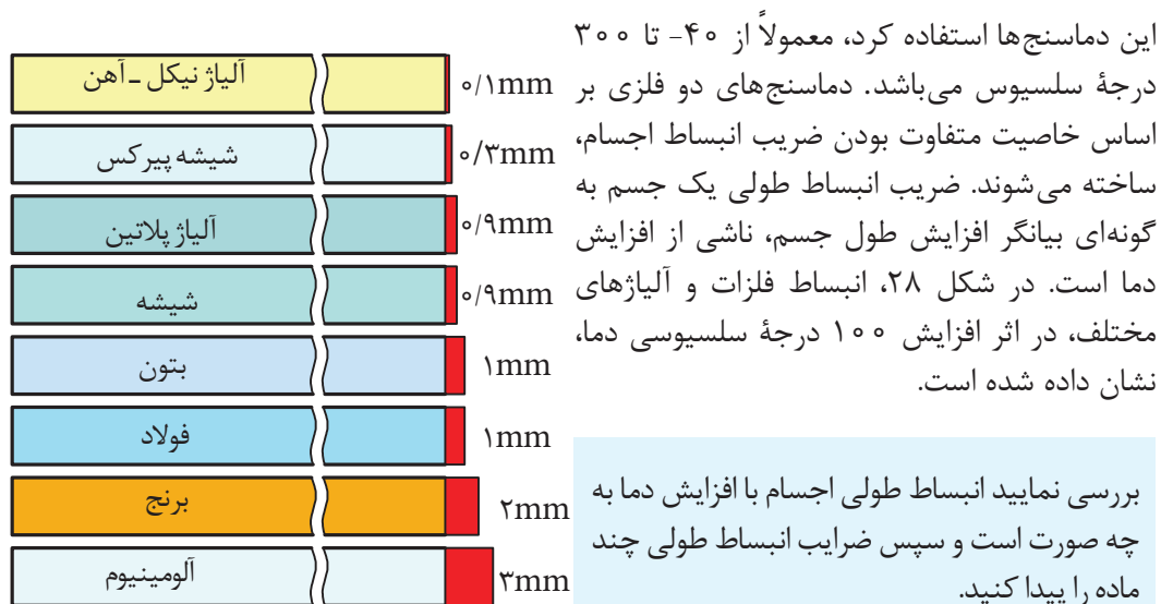
شکل ۲۸- میزان انبساط یک متر از اجسام مختلف در اثر افزایش دمای ۱۰۰ درجه سلسیوس
