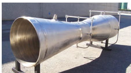
شکل ۲۱- یک نمونه ونتوری متر صنعتی
