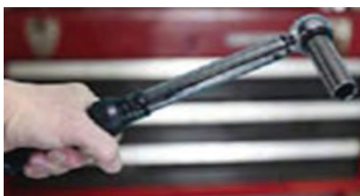
شکل ۲۴- آچار ترک یا آچار گشتاور
