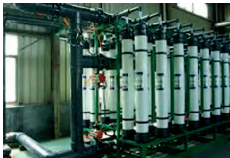
شکل ۱۰- نمایی ساده و واقعی از فرایند اولترافیلتراسیون
