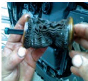
شکل ۳۴- فیلتر روغن مستعمل
