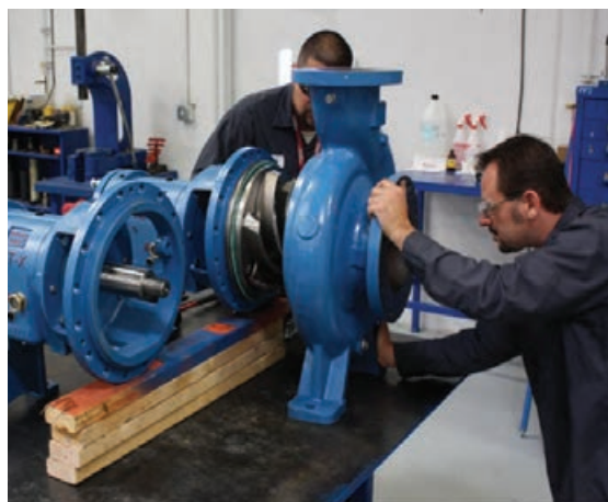
شکل ۲- تعمیر اساسی پمپ در کارگاه مکانیک
