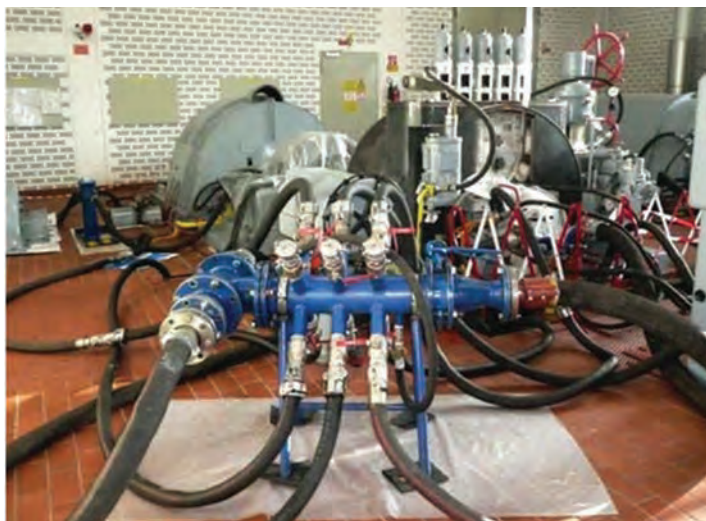
شکل ۳۰- سامانه تمیزکاری کمپرسور
