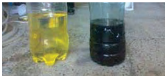
شکل ۲۳- مقایسه چشمی روغن تمیز و کثیف
