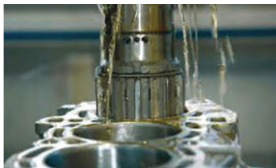
شکل ۲۱- روغن کاری هیدرواستاتیکی
