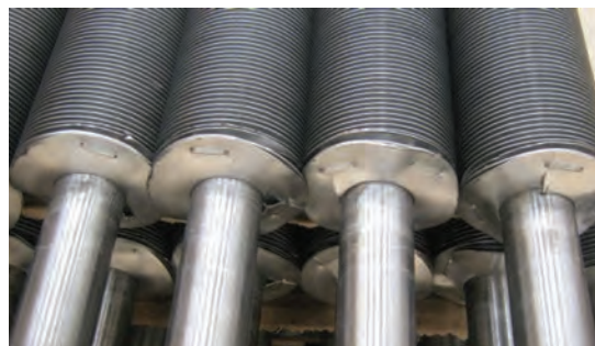
شکل ۲۶- لوله‌های پره‌دار در خنک‌کننده‌های هوایی
