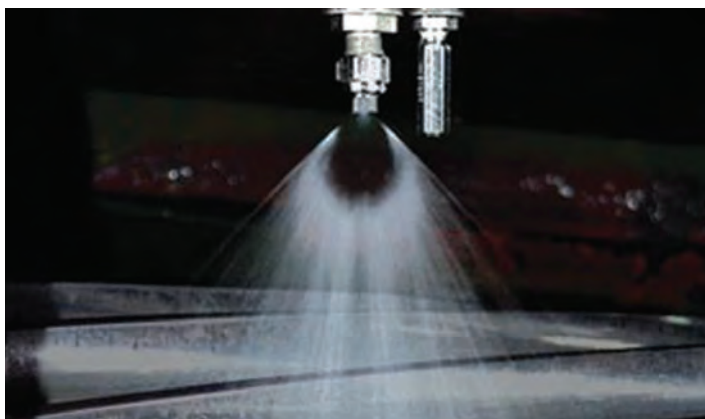
شکل ۲۰- روغن‌کاری پاششی
