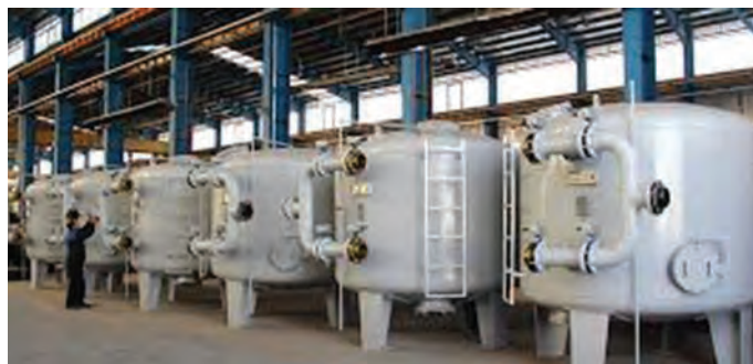
شکل ۵- نمای درونی و بیرونی صافی صنعتی
