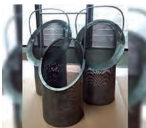
شکل ۳۵- یک نمونه فیلتر اولیه سوخت
