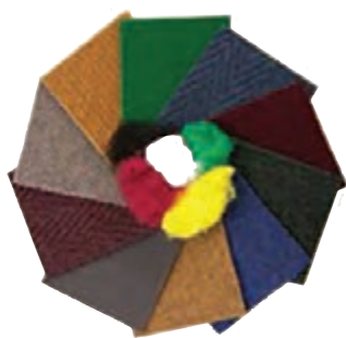
شکل ۷ - نمونه‌ای از منسوجات بی‌بافت تهیه شده از طریق روش سوزن زنی
