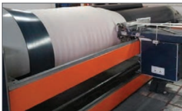
شکل ۱۲- ماشین چله پیچ بخشی
