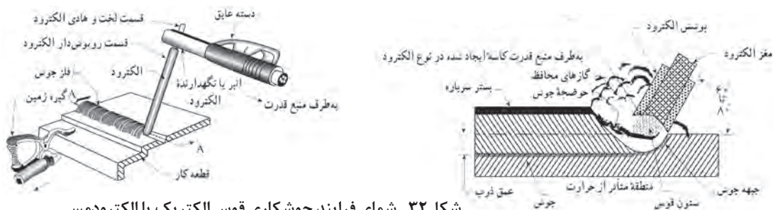
شکل ۳۲- شمای فرایند جوشکاری قوس الکتریک با الکتروود دستی
