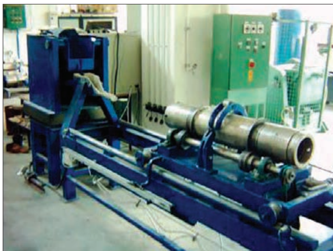
شکل ۱۳- نوع دیگر از ماشین گریز از مرکز افقی
