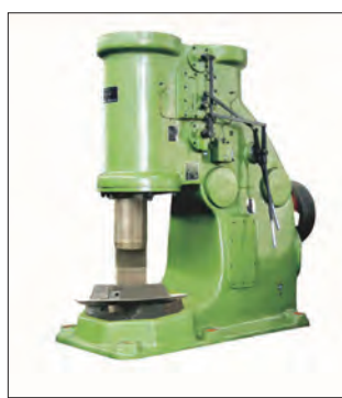
شکل ۲۹- الف) دو نمونه از ماشین‌های پرس یا چکش‌های نیوماتیکی (ب) نمونه‌ای واقعی از یک پرس پتک‌کاری
