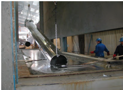
شکل ۲۵- فرایند گالوانیزه کردن
