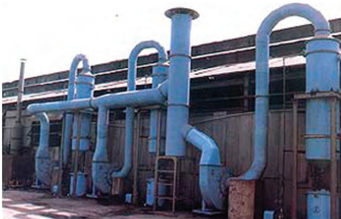
شکل ۱۸- سیستم سایش نیوماتیکی برای احیای ماسه به روش خشک
