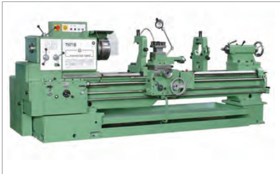
شکل ۳۱- کاربرد چدن در دستگاه تراش
