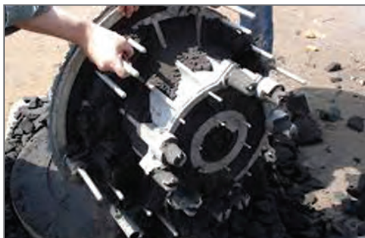
شکل ۱۰- قطعه هوزینگ ریخته شده سالم
