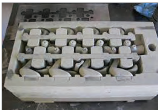
شکل ۲- قالب درجه زیرین یک قطعه صنعتی
