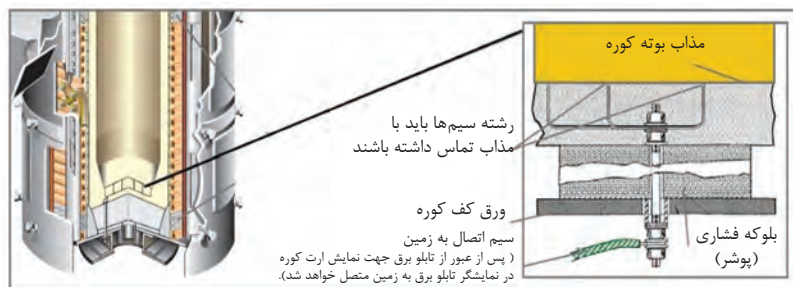
شکل ۱۰- شماتیک اتصال سیم ارت در کوره القایی
