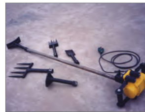
شکل ۱۲- کوبه ماشینی با سرهای قابل تعویض
