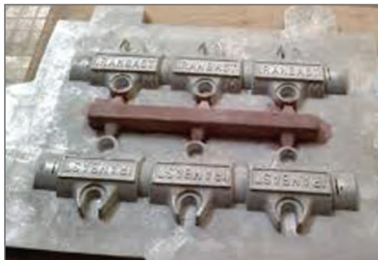
شکل ۶- راهبار و راهبارها روی مدل صفحه‌ای
