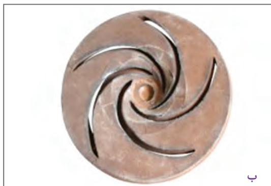
شکل ۱۶- الف) جعبه ماهیچه CO 2 و ب) ماهیچه خارج شده از آن
