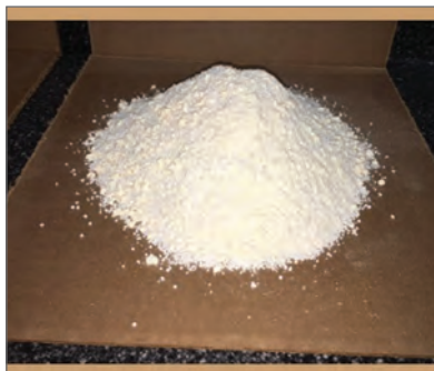
شکل ۴- عایق های ریختنی
