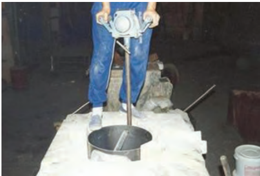
شکل ۱۹- نحوه کوبش دیواره کوره توسط کوبه ماشینی
