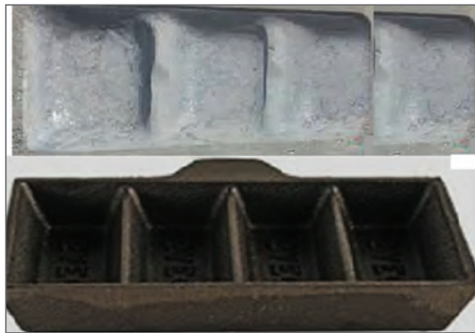
شکل ۵- قالب ریژه شمش ریزی
