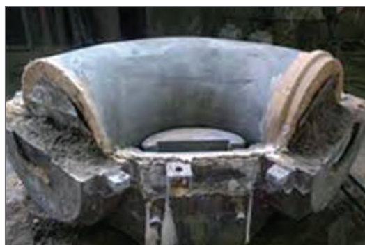
شکل ۱۷- ماهیچه زانویی پوشش داده شده
