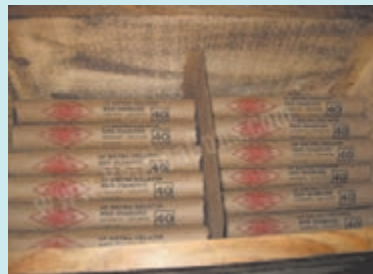
دینامیت های چیده شده درون جعبه چوبی
