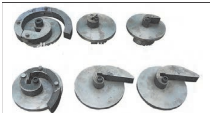
شکل ۳-۲۷- چند نمونه قالب خمکاری با شعاع های گوناگون
