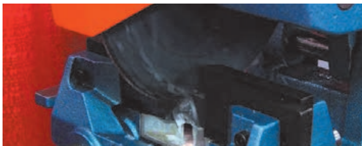
شکل ۱-۱۹- برشکاری با اره آب صابونی
