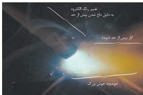
شکل ۴-۳۴: جوشکاری با آمپر بسیار بالا
