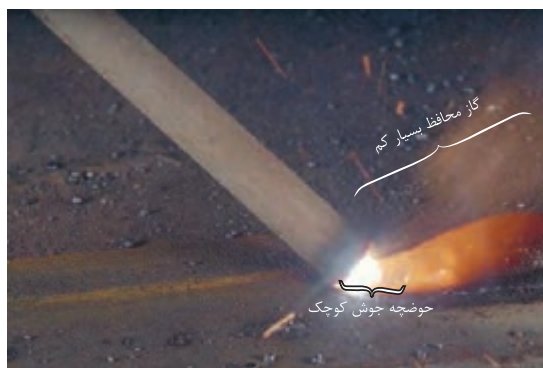
شکل ۴-۳۳: جوشکاری با آمپر بسیار پایین
