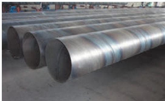
شکل ۲-۲: لوله درز دار
