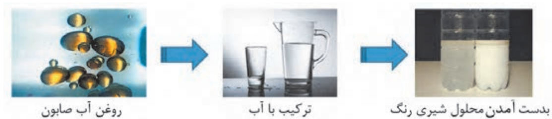
شکل ۱-۱۷- روش تهیه آب صابون
