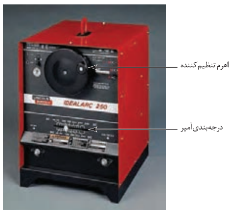
شکل ۴-۱۵: دستگاه جوشکاری با سیم پیچ متحرک
