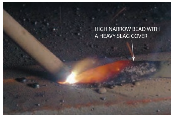
شکل ۴-۳۷: جوشکاری با طول قوس بسیار کم
