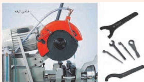
شکل ۱-۲۱- ضامن و انواع آچار تعویض تیغه در اره آب صابونی
