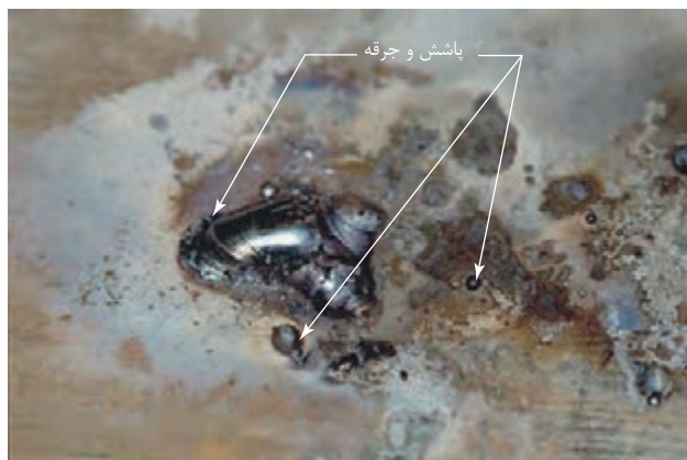
شکل ۴-۳۵: پاشش سخت شده بر روی فلز پایه
