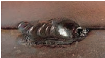
شکل ۴-۵۹: مقطعی باید کوچک و یکنواخت باشد تا تاثیر به جوش نهایی نداشته باشد
