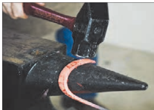
شکل ۳-۴- خم‌کاری دستی به کمک قالب و چکش
