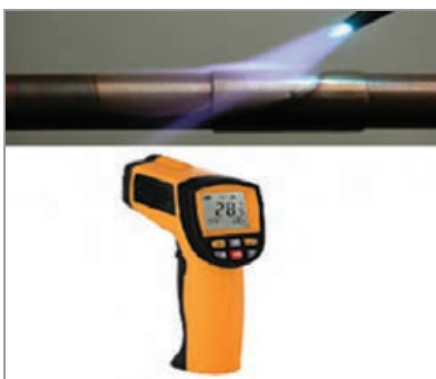
شکل ۴-۱۹- اندازه‌گیری دما توسط ترمومتر
