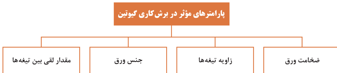
شکل ۱-۱۰- پارامترهای برش کاری با گیوتین
