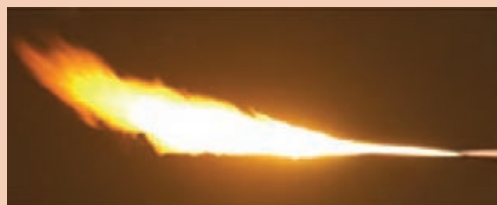
شکل ۳-۳۹- تنظیم شعله احیا (کربن ده)
