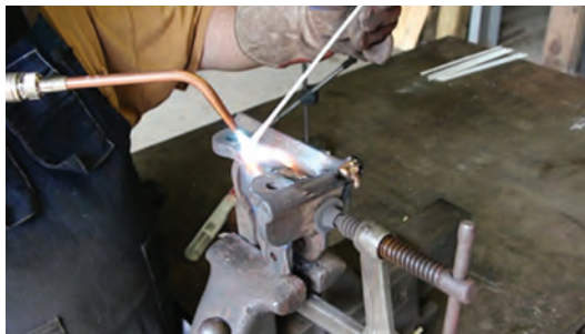
شکل ۴-۱۵- فیکسچر مورد استفاده شده در فرایند زردجوش
