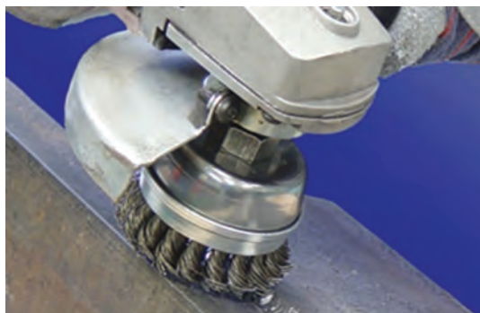
شکل ۱۱-۴ - تمیزکاری توسط ابزارهای مکانیکی
