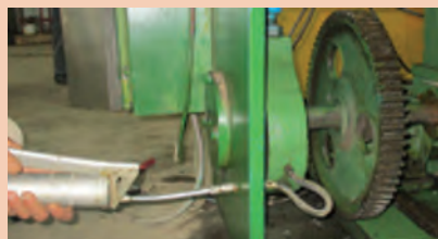
شکل ۱-۱۶- سرویس دوره‌ای گیوتین
