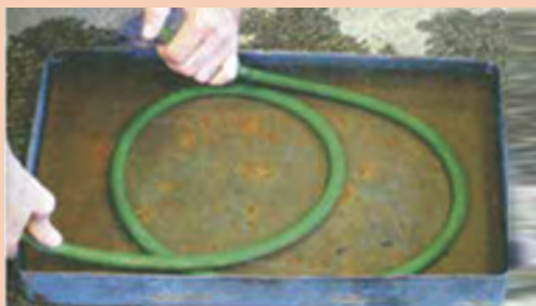
شکل ۳-۳۸- کنترل سلامت شیلنگ‌ها
