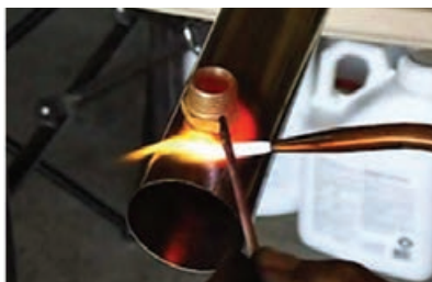
شکل ۴-۱۷- استفاده از شعله اکسی‌استیلن
