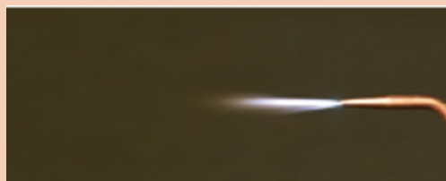
شکل ۳-۴۰- تنظیم شعله اکسید
