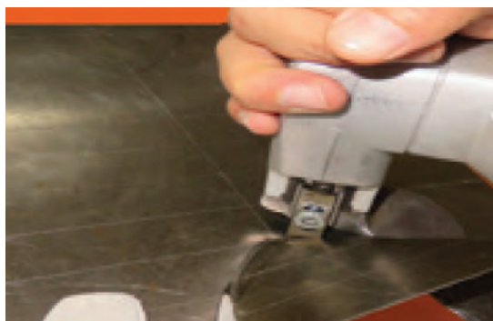
شکل ۱-۲۱- روش برش کاری با نیبلر دستی
