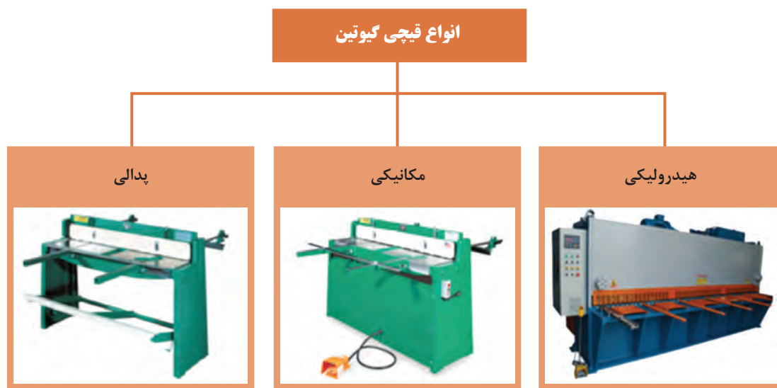
شکل ۳-۱- انواع گیوتین از نظر نحوه انتقال قدرت
