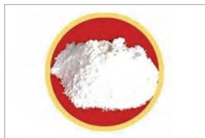
شکل ۳-۴-۱ روان ساز پودری مورد استفاده در زردجوش
