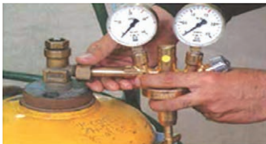
شکل ۳-۱۸- بستن رگولاتور به کپسول
