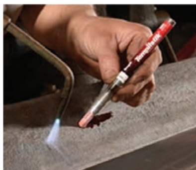
شکل ۴-۱۸- اندازه‌گیری دما توسط گچ‌های حرارتی
