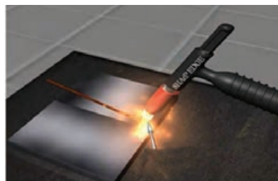
شکل ۴-۱۶- استفاده از قوس الکتریکی
