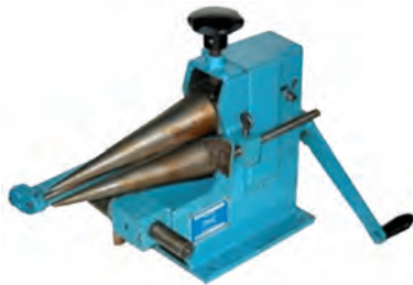
شکل ۲-۲۲ نورد خاص در تولید مخروط ناقص
