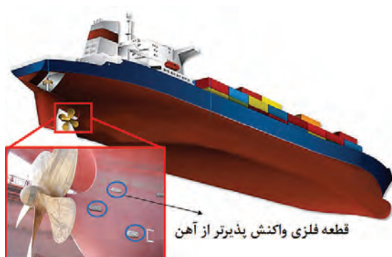
شکل ۱۲. چگونگی حفاظت کاتدی بدنه کشتی
