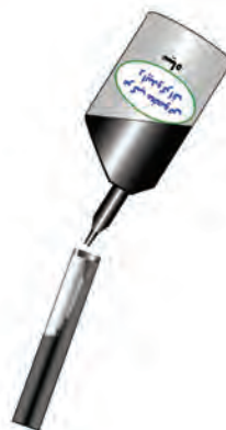
۲- ریختن مرکب مخصوص درون مخزن قلم
