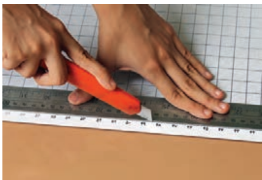
شکل ۴۰-۱- روش برش لبه اضافی کاغذ با کاتر
