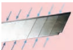
شکل ۱-۸- شیارهای روی تیغه کاتر
