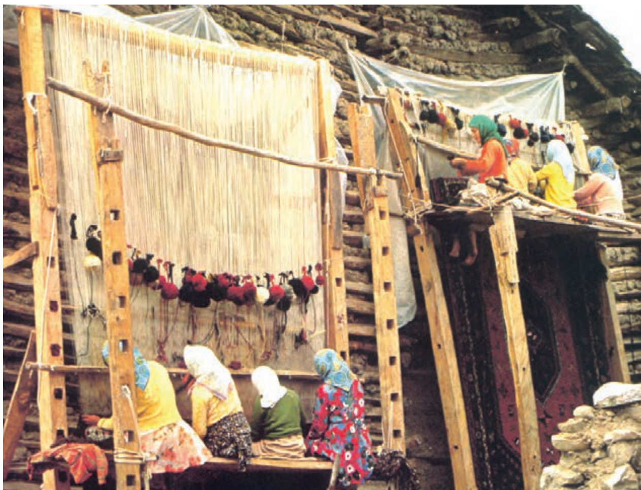
تصویر ۱-۱۰ ▲ بافندگان در حال بافت بر روی دار بدون حفاظ (احتمال خطر افتادن)
