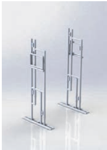
شکل ۵۶-مستقر ساختن اُستون‌ها
