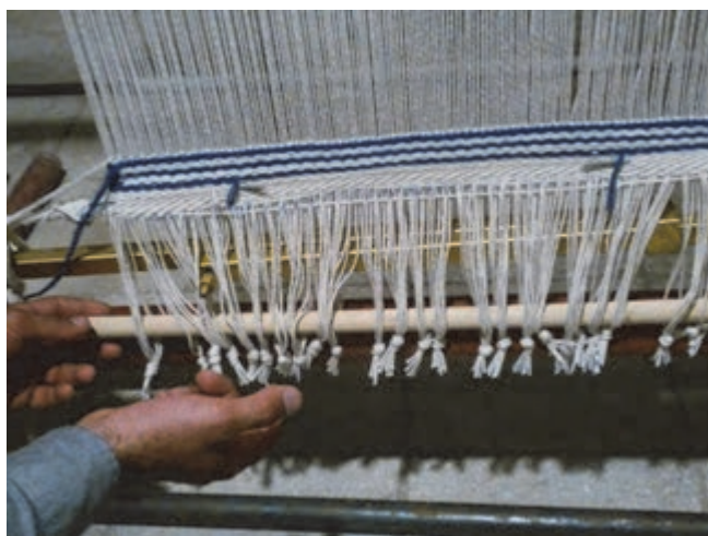
شکل ۸۹- قرار دادن چوب مهار
