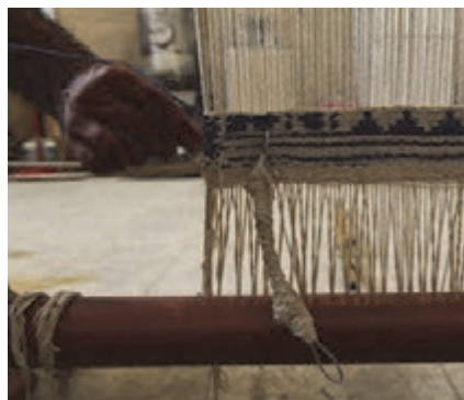
شكل ۷۶- عبور حلقه از داخل سوزن
