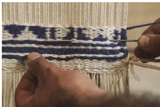
شكل ۷۵- قرار دادن سوزن مهيار در داخل بافته
