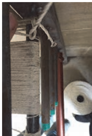
شکل ۳۳- عبور دادن نخ به صورت حلقه‌ای در سرکار
