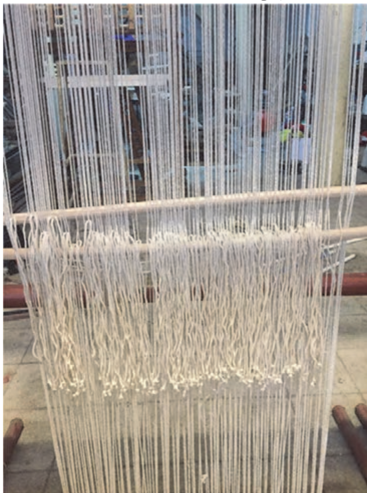
شکل ۵۴ - قرار دادن گرت‌های نقش بر روی چله‌ها
