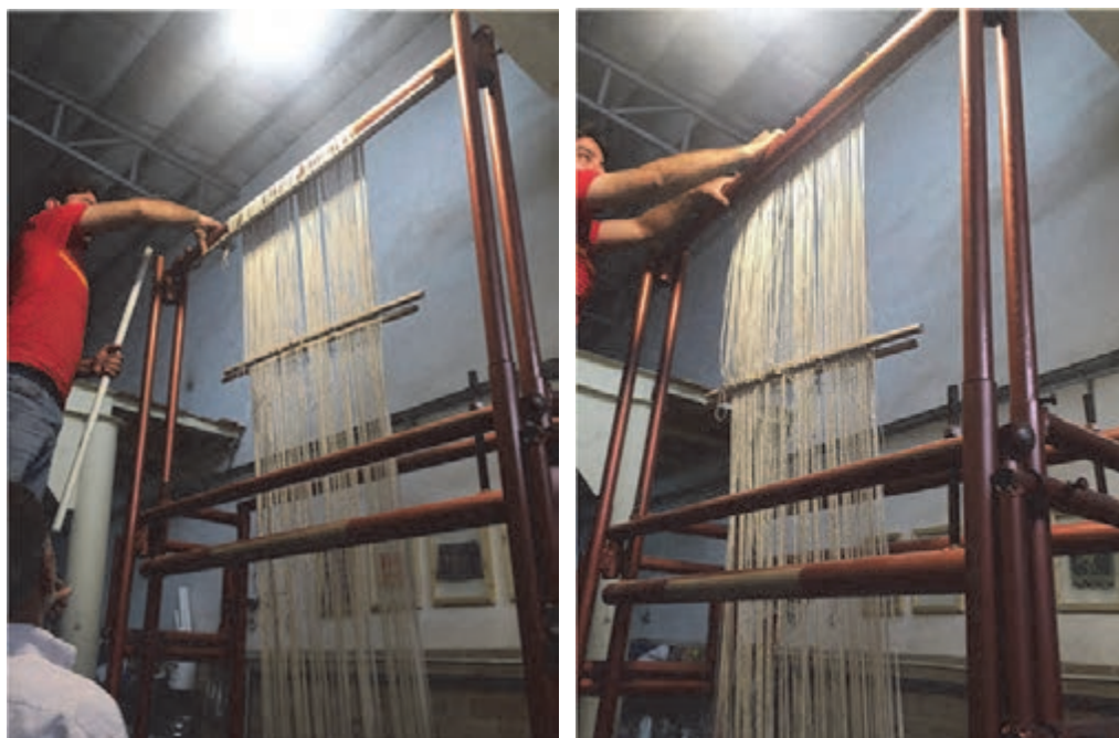
شکل ۴۳- بستن چله‌ها بر روی تیر بالا
