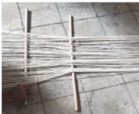
شکل ۳۷- قرار دادن چوب‌های گُرت در داخل چله
