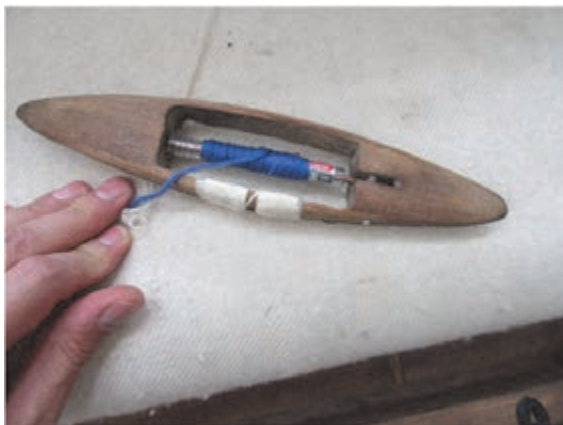
شکل ۲۰- ماسوره (ماسوره که نخ به دور آن پیچیده شده، درون ماکو قرار دارد)
