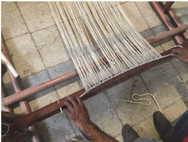
شکل ۴۱- بستن چله بر روی تیر پایین
