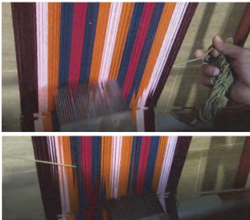
شکل ۲۲- کوبیدن پود در هنگام بافت
