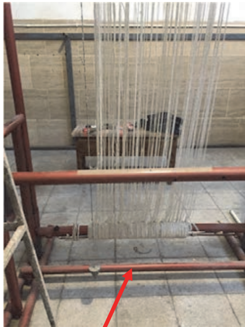
شکل ۴۴- تنظیم چله‌ها به کمک شاغول
