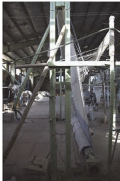
شکل ۴۸- دستگاه متحرک با اتصالات پیچ و مهره
