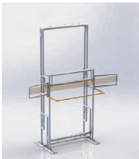
شکل ۶۵- قرار دادن میله پشت بند
