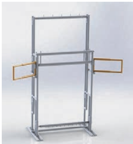
شکل ۶۳- باز کردن چوشلیت (مهار شلیت)
