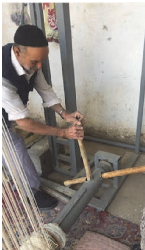
شکل ۶۶- تنظیم فشار چله‌ها
