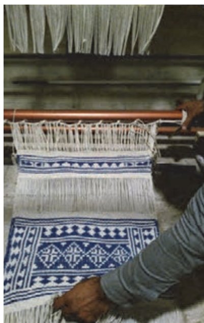
شکل ۸۶- آزاد کردن زیلو از تیر پایین
