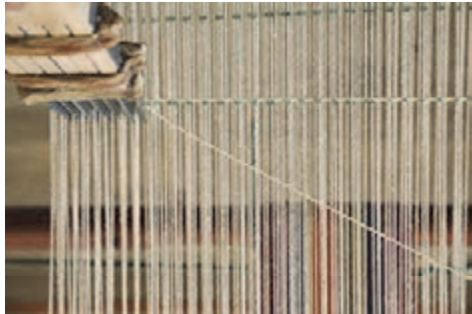
شکل ۷۱- کوبیدن پود به وسیله پنجه
