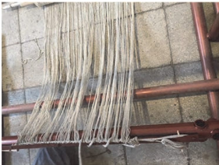
شکل ۴۲- ته دوزی کردن تارها
