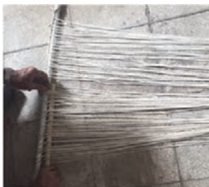
شکل ۳۷- قرار دادن چوب‌های گُرت در داخل چله
