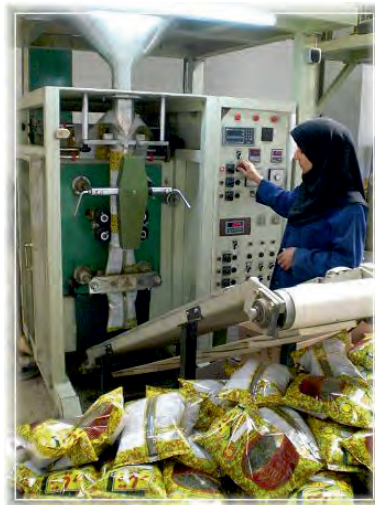
شکل ۲-۱۳- دستگاه بسته بندی سبزی
