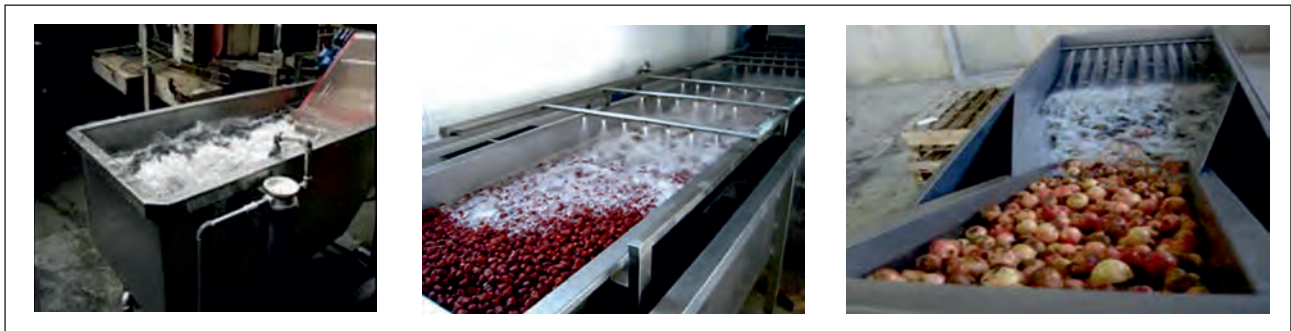
شکل ۱-۳۰- دستگاه شست و شوی میوه
