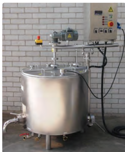
شکل ۱-۱۷- سیستم پاستوریزاسیون غیرمداوم
