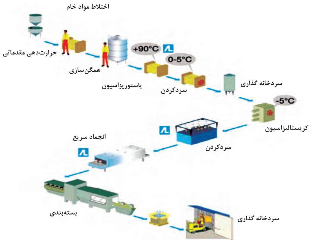
شکل ۳-۸ - فرایند تولید بستنی
