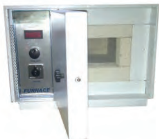
شکل ۲-۱۶- وسایل مورد استفاده برای آزمایش اندازه‌گیری خاکستر
