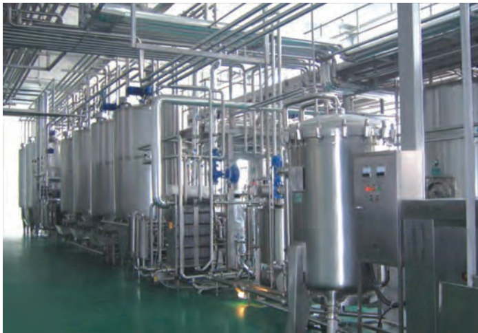
شکل ۱-۱۵- خط تولید شیر پاستوریزه
