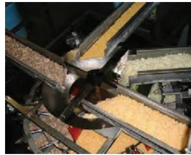
شکل ۵ - سیستم توزین چندگانه
