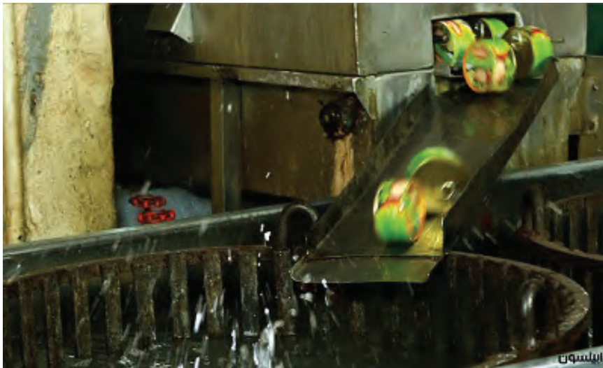
شکل ۲- وارد شدن قوطی‌های فلزی به سبدهای اتوکلاو
