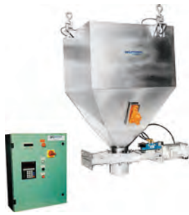
شکل ۶ - سیستم توزین هاپر
