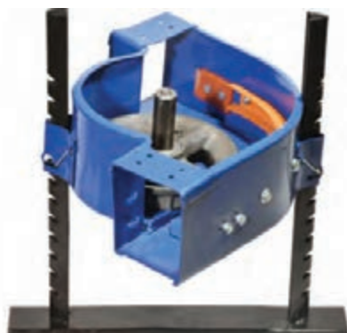
مخزن دان (هاپر) و الکتروموتور
