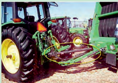
شکل ۴۵-۱ اتصال شیلنگ‌های هیدرولیک (الف) (ب)
