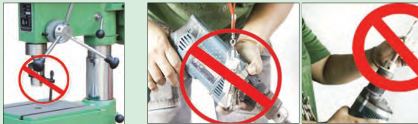
شکل ۵-۵۰- نکات ایمنی در سوراخ کاری
