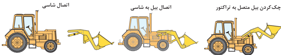
شکل ۷۰-۱- مراحل اتصال بیل به تراکتور
