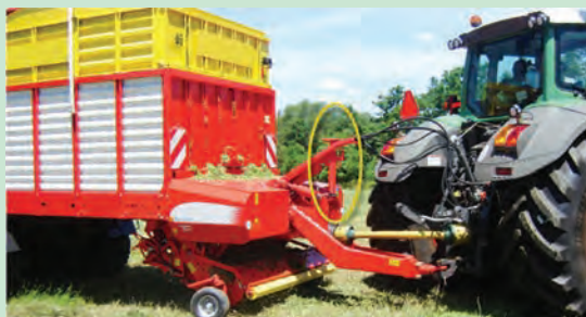
شکل ۴۵-۱ اتصال شیلنگ‌های هیدرولیک (الف) (ب)
