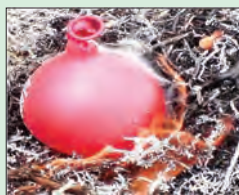
(ج) ذوب نشدن ظرف پلاستیکی حاوی آب روی آتش
