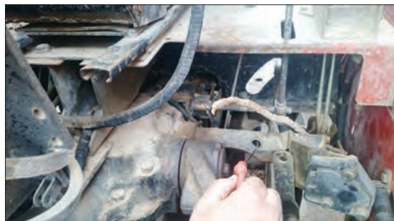
شکل ۲۷-۴- گیج روغن هیدرولیک تراکتور فرگوسن ۳۹۹
