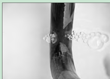
شکل ۷۵-۴- تشخیص پنچری تیوب
