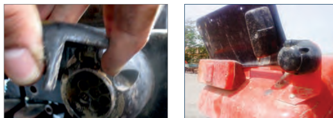
شکل ۲۳-۱- پریز برق تراکتور
