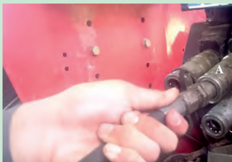
شکل ۲۶-۱- اتصال خروجی هیدرولیک
