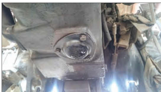
شکل ۳۰-۴- درپوش تخلیه روغن هیدرولیک تراکتور MF ۲۸۵
