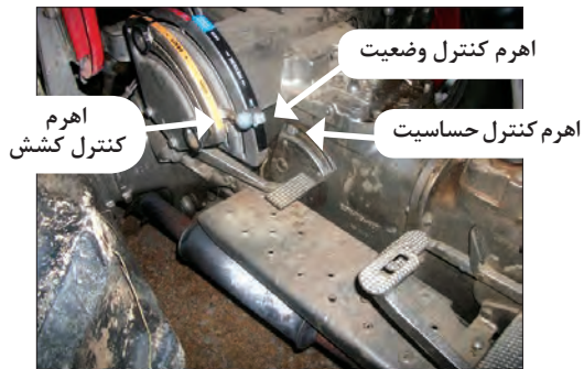
شکل ۱۹-۱- اهرم های کنترل هیدرولیک تراکتور فرگوسن ۲۸۵
