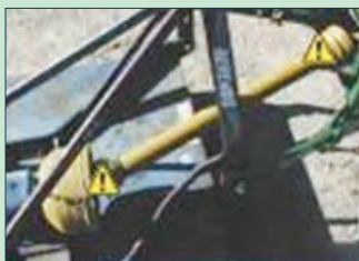
شکل ۳۶-۱- حداکثر زاویه گاردان ۲۵ درجه است.
