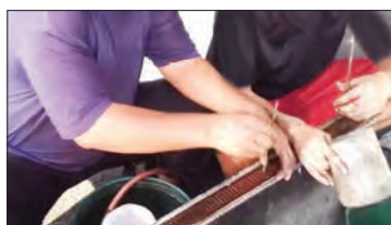
شکل ۲۸-۳ سیخ زدن رادیاتور
