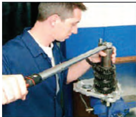
شکل ۱۰-۲ کار با ترک‌متر قابل تنظیم
