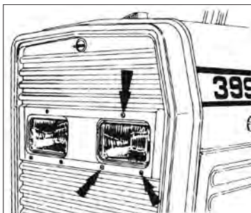
شکل ۱۶-۴- پیچ های تنظیم چراغ
