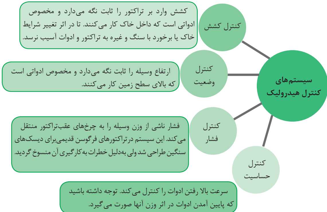
نمودار ۱-۱- انواع سیستم‌های کنترل هیدرولیک تراکتور
