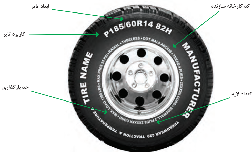
شکل ۴-۶۰- مشخصات فنی و ظاهری تایر
