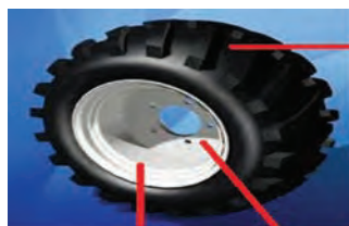
دیسک رینگ (طوقه) شکل ۵۲-۴- اجزای چرخ لاستیکی
