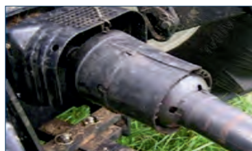
شکل ۳۳-۱- گاردان مجهز به کلاچ یک‌طرفه
