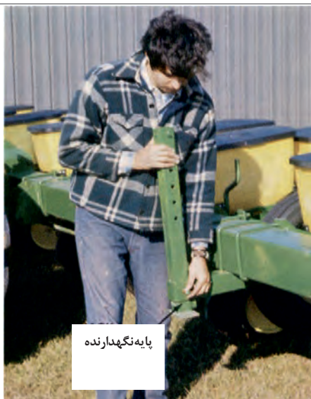
شکل ۳۹-۱- جدا کردن ماشین از تراکتور
