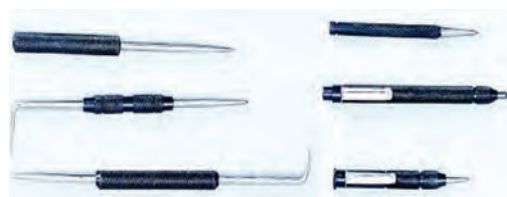
شکل ۱۹-۵- انواع سوزن خط‌کشی
