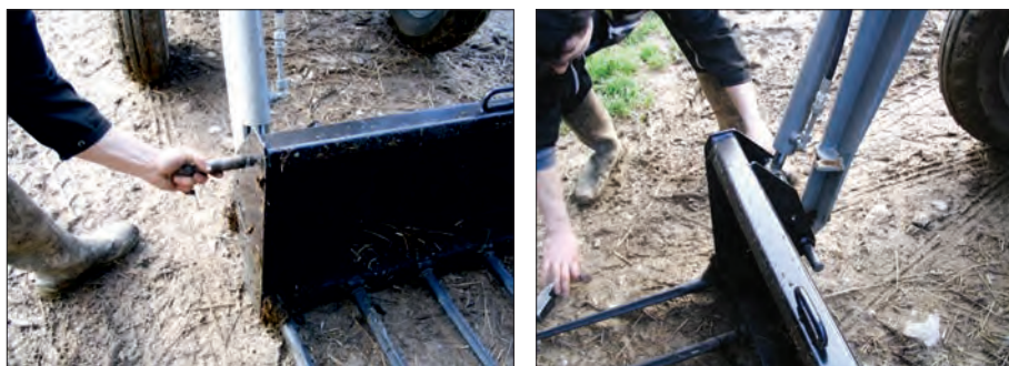
(الف) (ب) شکل ۱-۶۷- اتصال باکت‌ها به بیل
