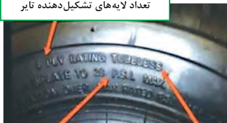
شکل ۴-۶۴- مشخصات فنی تایر
