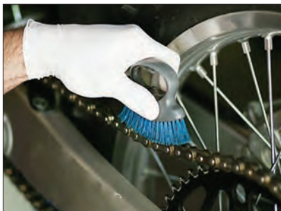
شکل ۲۸-۲- تمیز کردن زنجیر
