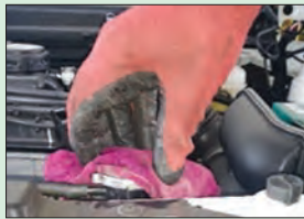
شکل ۲۹-۳ باز کردن درب رادیاتور
