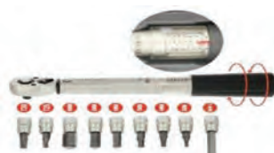
شکل ۱۳-۲- تنظیم ترک متر قابل تنظیم
