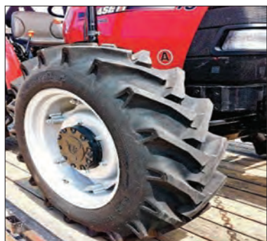
شکل ۴-۶۸- چرخ با فشار باد توصیه شده
