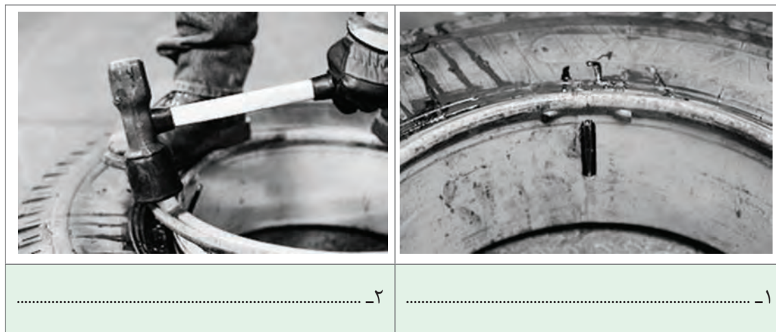
شکل ۷۹-۴ الف - جازدن تایر روی رینگ دو تکه
