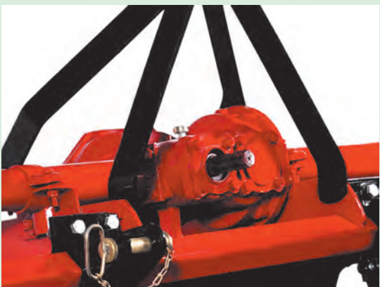
شکل ۲۳-۱. محور انتقال نیرو و نقاط اتصال
