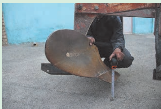
شکل ۳۰-۱. اندازه‌گیری فاصله تیغه جهت تراز عرضی
