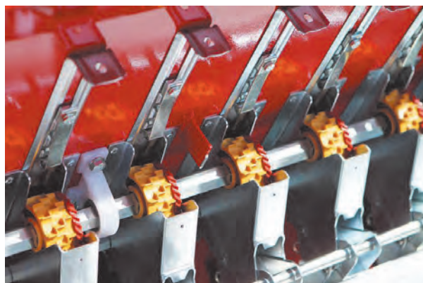
ب- موزع غلتکی دندانه دار
