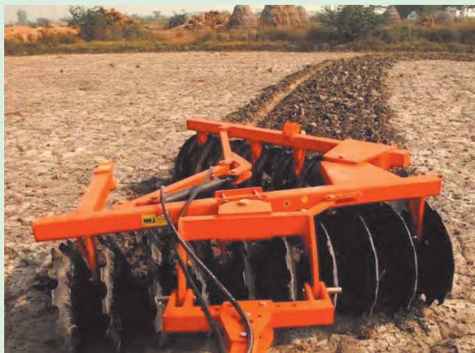
الف. تنظیم زاویه برش به وسیله جک
