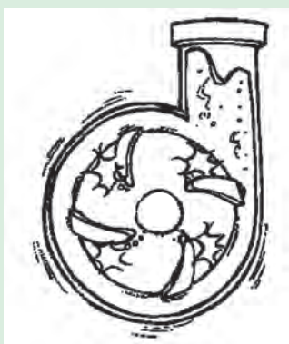
شکل ۲۹-۵. کاویتاسیون در پروانه پمپ
