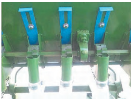
شکل ۳-۲۶. دریچه تغذیه در خطی کار
