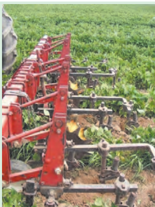
شکل ۱۳-۴. پنجه شاخه ای در حال کار
