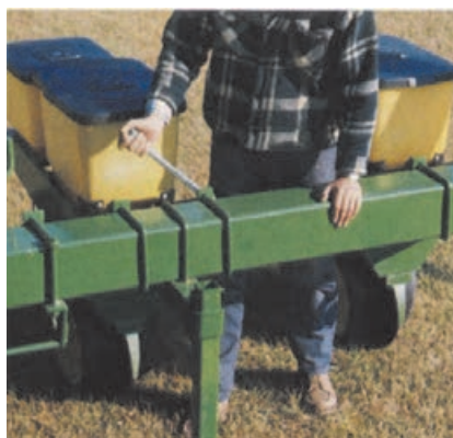
شکل ۲۵-۳. جابجایی ردیف‌های کاشت در ردیف کار
