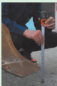
شکل ۳۰-۱. اندازه‌گیری فاصله تیغه جهت تراز عرضی
