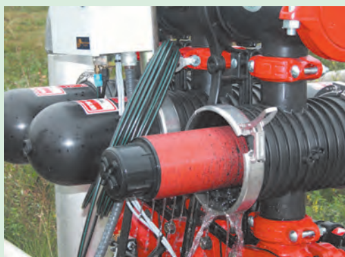
شکل ۵-۶۰. شست و شوی دستی صافی دیسکی
