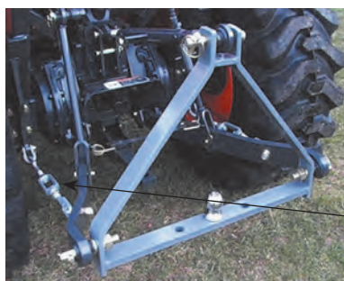
زنجیر تعادل (نوسان گیر) شکل ۲۷-۱
