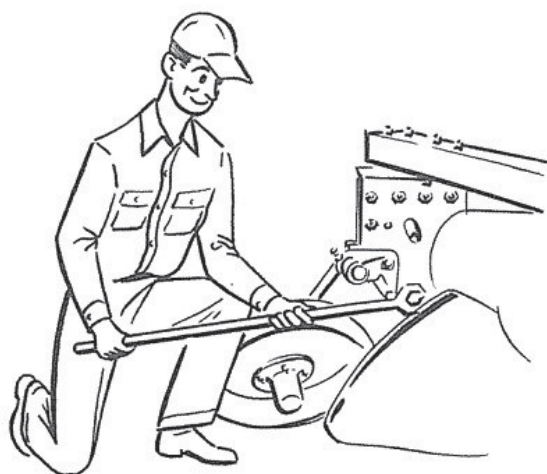
شکل ۵۱-۱. آچارکشی گاوآهن
