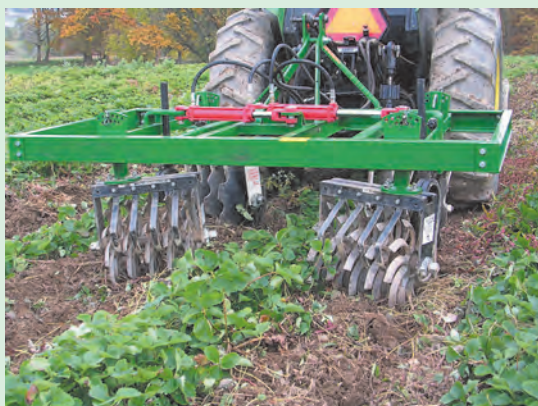
شکل ۱۲-۴. پنجه غلتان در حال کار
