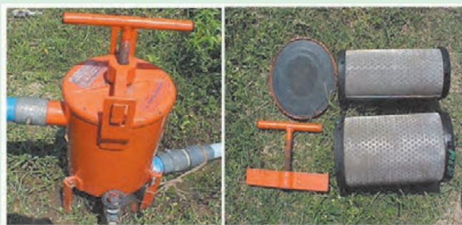
شکل ۵۷-۵. قطعات باز شده صافی توری
