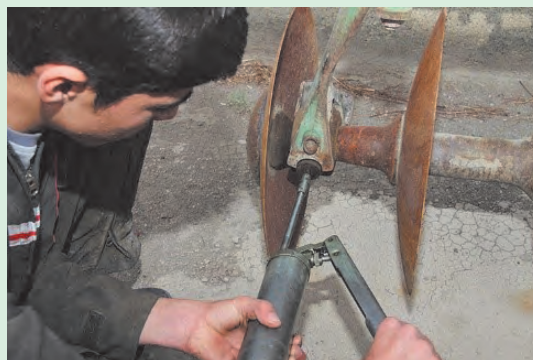
شکل ۱۶-۲. گریس کاری دیسک
