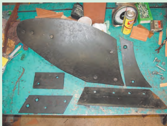
شکل ۲۰-۱. چیدمان اجزای بازشده خیش در کنار یکدیگر
