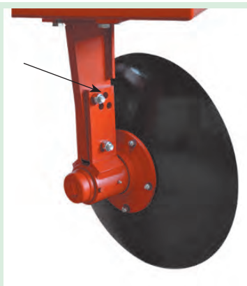
شکل ۴۲-۲. تنظیم زاویه بشقاب
