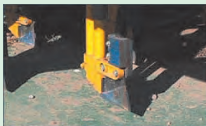
ج- شیار بازکن بیلچه‌ای
