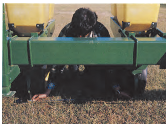
شکل ۲۵-۳. جابجایی ردیف‌های کاشت در ردیف کار
