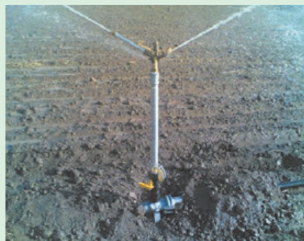
شکل ۴۱-۵. آبپاش مستقر شده روی شیر خودکار
