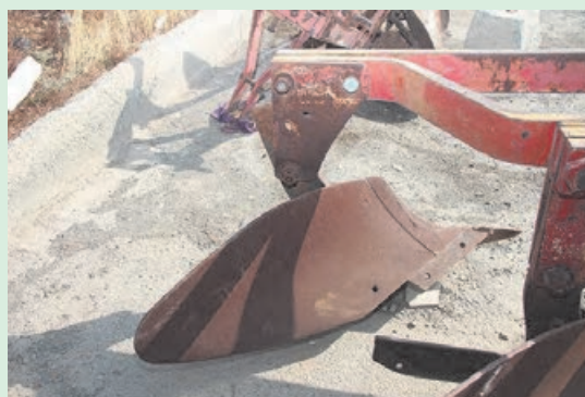
شکل ۲۱-۱. پین بریده شده در گاواهن
