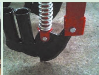
الف- شیار بازکن کفشی
