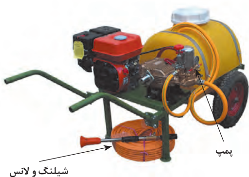
شکل ۲۹-۴. سم‌پاش فرغونی و اجزای آن
