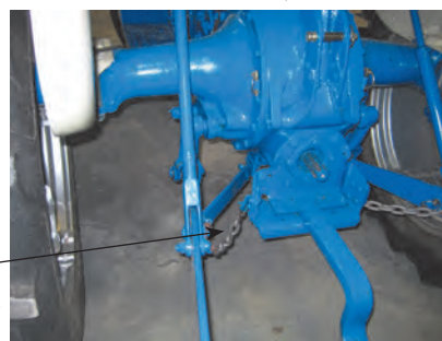
زنجیر تعادل (نوسان گیر) شکل ۲۷-۱
