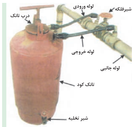
شکل ۴۹-۵. اجزای سیستم توزیع کود
