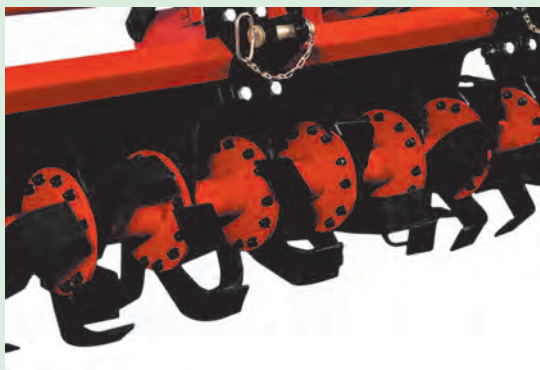
شکل ۲۲-۱. نقاط اتصال تیغه‌ها به فلانج
