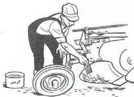
شکل ۵۲-۱. اندود کردن قطعات گاوآهن با مواد ضدزنگ
