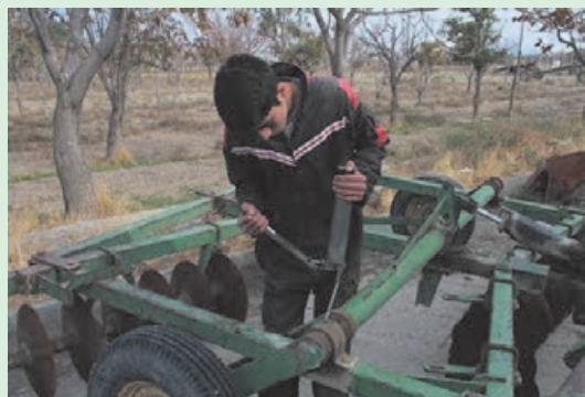
شکل ۱۶-۲. گریس کاری دیسک
