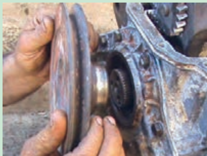
شکل ۳۵. پیاده کردن پولی میل لنگ
