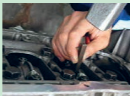
شکل ۴۱. علامت زدن کپه شاتون
