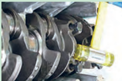
شکل ۴۷. شل کردن کپه‌های یاتاقان
