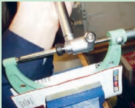
شکل ۷۶. اندازه‌گیری قطر سیلندر با میکرومتر داخلی
