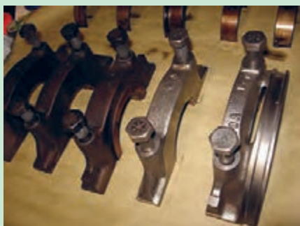
شکل ۴۸. برداشتن کپه‌های یاتاقان و چیدن آنها
