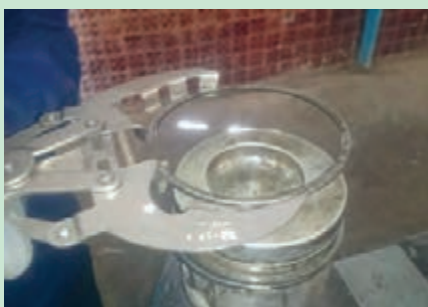
شکل ۵۲. نحوه خارج کردن رینگ از روی پیستون
