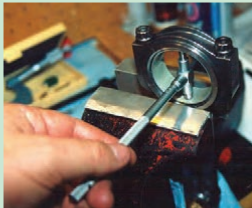
شکل ۸۳. کنترل بیضی شدن سر بزرگ شاتون
