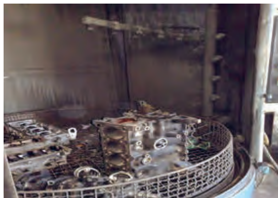
شکل ۶۱. شستشوی موتور به وسیله دستگاه شات بالاست
