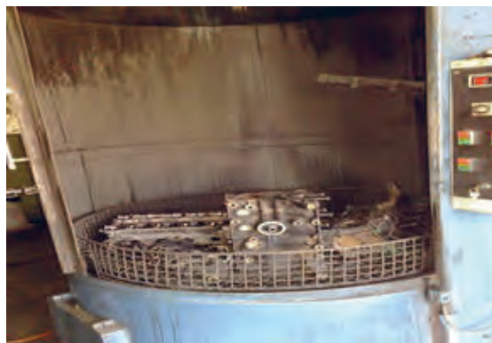
شکل ۶۱. شستشوی موتور به وسیله دستگاه شات بالاست
