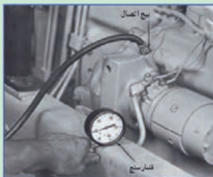
شکل ۵۰. فشار سنجی مدار روغن کاری
