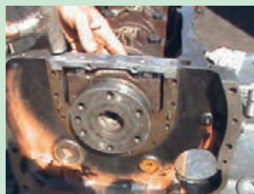
شکل ۹۷. جا زدن قطعه آب بندی کارتر
