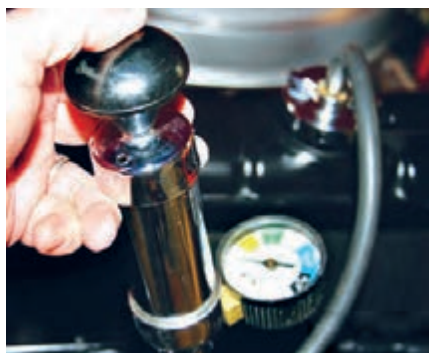
شکل ۶. آزمایش نشت یابی تحت فشار
