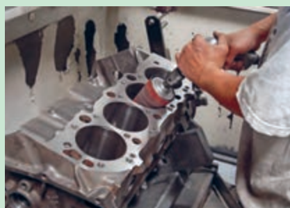
شکل ۳۹. ترمیم لبه بالای سیلندر
