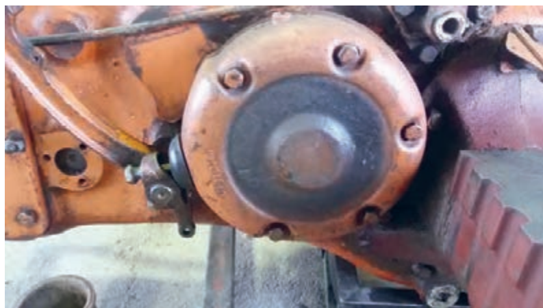
شکل ۴. موقعیت ترمز تراکتور U650
