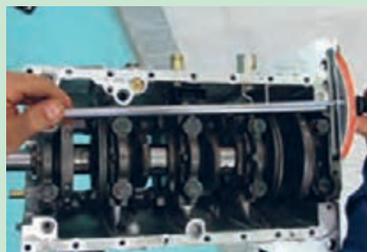
شکل ۴۶. باز کردن پیچ‌های یاتاقان
