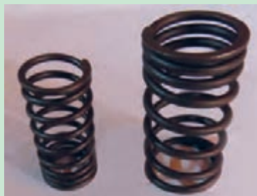
شکل ۱۸. فنرهای سوپاپ در تراکتور MF۲۸۵
