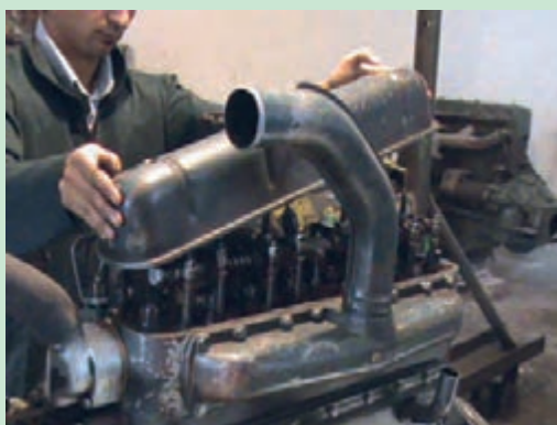
شکل ۴۴. برداشتن درپوش سوپاپ‌های تراکتور U650
