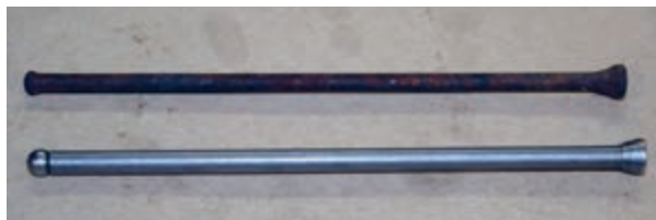
شکل ۷۶. زنگ زدن و شکستگی میل تپت
