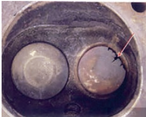
شکل ۷۰. عیوب ظاهری سوپاپ‌ها
