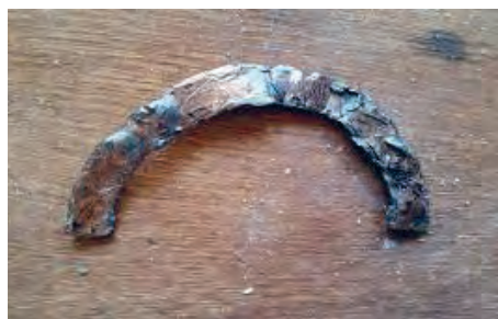
شکل ۷۳. نمونه بغل یاتاقانی معیوب
