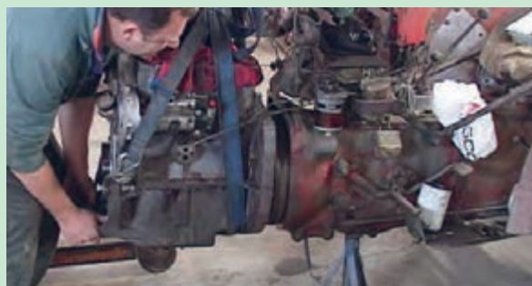
شکل ۳۲. جدا کردن موتور از جعبه دنده
