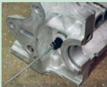
شکل ۵۹. تمیز کردن مجاری آب و روغن
