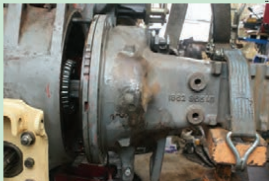
شکل ۷. باز کردن پوسته قیفی تراکتور MF۲۸۵
