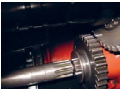
شکل ۲۰. محور تواندهی در حالت خلاص
