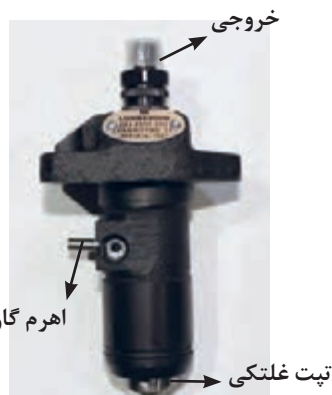
شکل ۲۷. پمپ انژکتور واحدی و موقعیت آن روی تراکتور باگی با موتور لمباردینی
