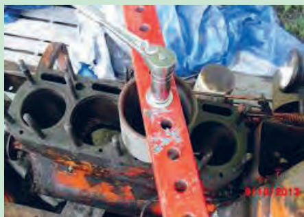
شکل ۹۰. جا زدن بوش با ابزار
