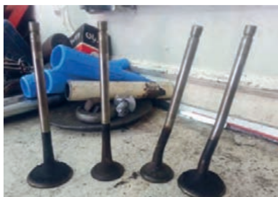
شکل ۶۷. کربن گرفتگی سرسیلندر و سوپاپ‌ها
