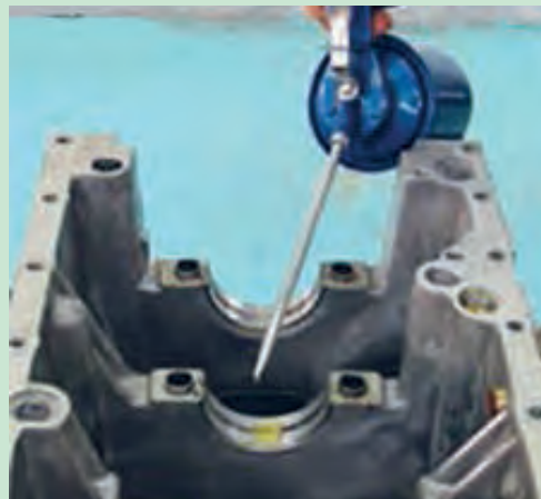
شکل ۹۵. روغنکاری یاتاقان ها قبل از نصب
