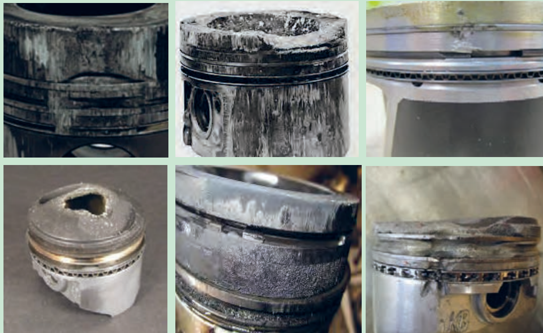
شکل ۷۴. نمونه ای از پیستون های معیوب
