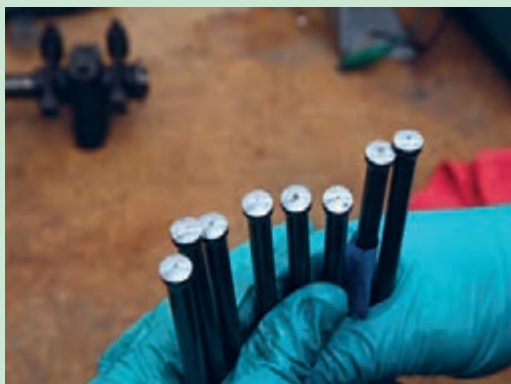
شکل ۴۷. خارج کردن میل تپت‌ها
