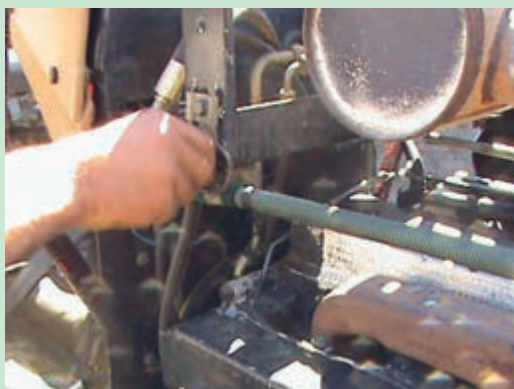
شکل ۴۱- باز کردن انباره اگزوز تراکتور MF۳۹۹
