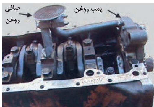
شکل ۴۱. پمپ روغن موتور و صافی آن
