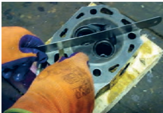
شکل ۶۵. کنترل تابیدگی سرسیلندر تراکتور دوچرخ
