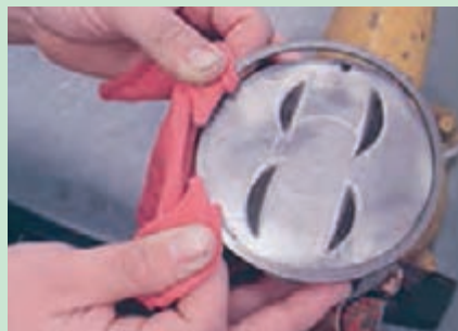
شکل ۵۳. خارج کردن رینگ بدون رینگ بازکن
