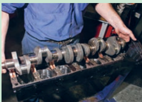
شکل ۴۹. برداشتن میل لنگ
