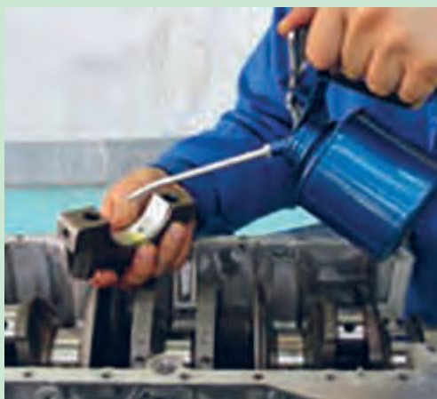
شکل ۹۵. روغنکاری یاتاقان ها قبل از نصب
