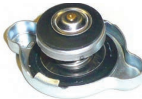
شکل ۱۲. درب رادیاتور و سوپاپ های آن
