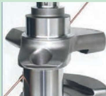
شکل ۶۰. تمیز کردن مجاری میل لنگ
