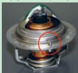
شکل ۴. Jiggle Valve
