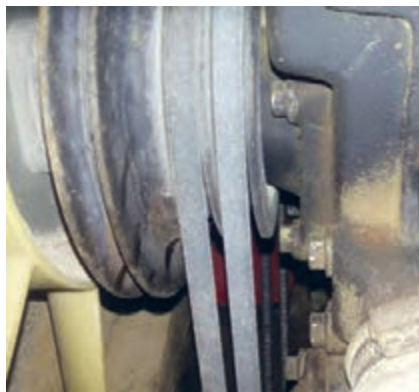
شکل ۷. استفاده از دو تسمه در تراکتور MF۳۹۹
