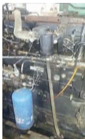
شکل ۳۹. تهویه محفظه کارتر در تراکتور MF399
