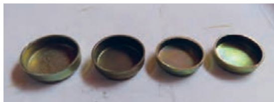
شکل ۲۹. انواع پولک سر سیلندر تراکتور و نشتی آب از پولک
