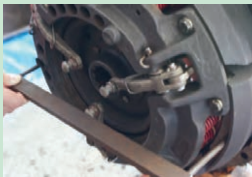
شکل ۳۸. تنظیم انگشتی‌های کلاچ
