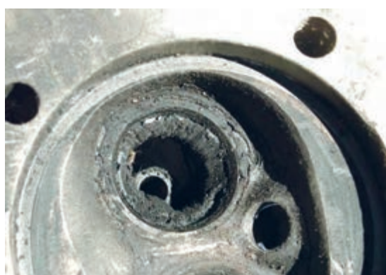
شکل ۶۷. کربن گرفتگی سرسیلندر و سوپاپ‌ها
