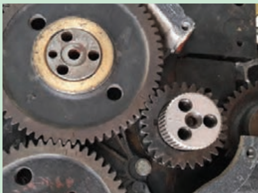
شکل ۱۰۹. علامت‌های تایمینگ روی چرخ دنده‌ها
