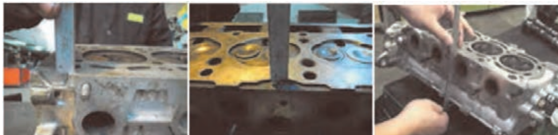
شکل ۸۳. کنترل ارتفاع مجاز کف تراشی سر سیلندر
