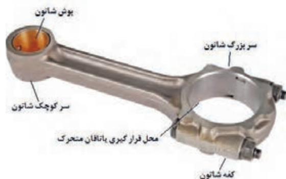
شکل ۱۳. اجزاء شاتون
