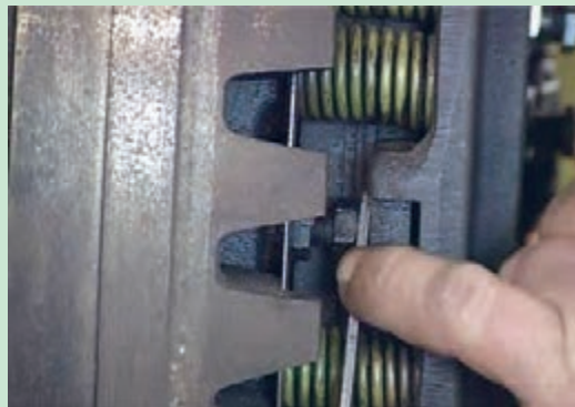
شکل ۳۹. تنظیم کلاچ محور تواندهی
