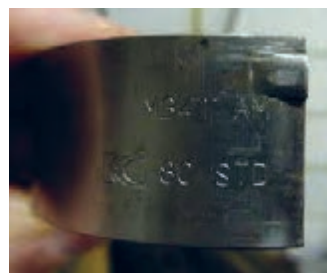
شکل ۲۳. تغییر ضخامت یاتاقان در سایزهای مختلف
