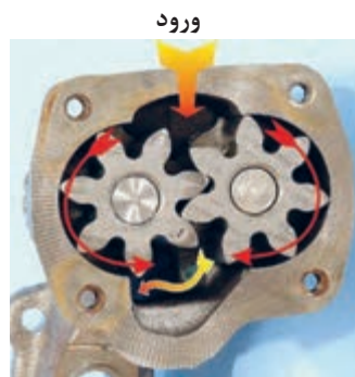
شکل ۴۲. پمپ روغن دنده ای
