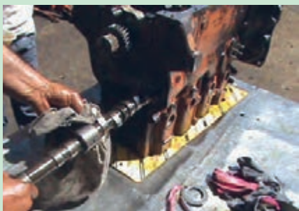
ب- خارج کردن میل سوپاپ
