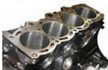
الف- سیلندر یکپارچه با بلوک سیلندر
