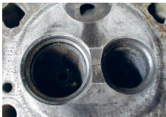
شکل ۶۶. ترک خوردگی سرسیلندر در محفظه احتراق
