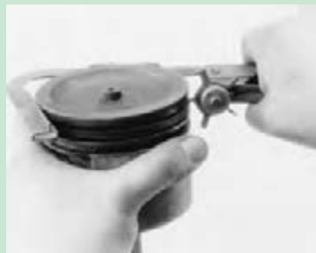
شکل ۵۸. روش های تمیز کردن شیار رینگ پیستون
