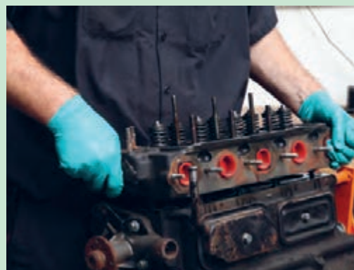
شکل ۴۸. برداشتن سرسیلندر
