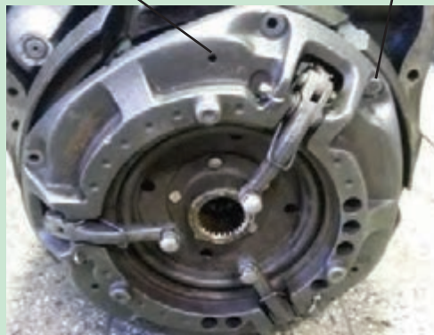
شکل ۲۵. جدا کردن مجموعه کلاچ از فلاپیول
