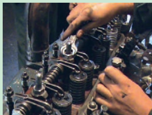
شکل ۴۵. باز کردن پیچ‌های پایه اسبک
