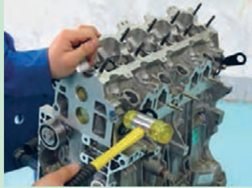
شکل ۴۹. آزاد کردن چسبیدگی سر سیلندر
