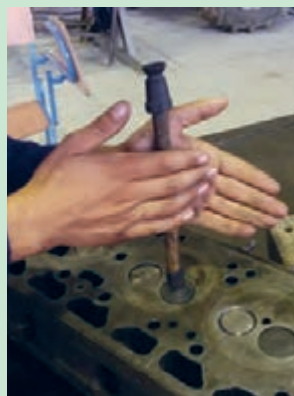
شکل ۷۹. چرخاندن سوپاپ به وسیله چوب سوپاپ گردان
