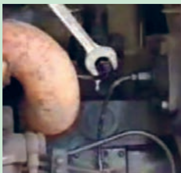
شکل ۲۹. شل کردن مهره لوله پر فشار انژکتور
