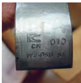
شکل ۲۳. تغییر ضخامت یاتاقان در سایزهای مختلف
