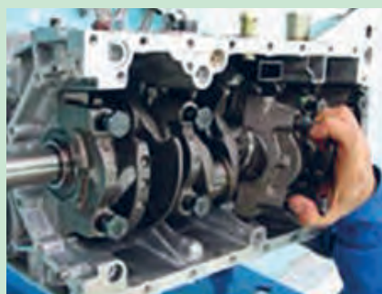
شکل ۴۸. برداشتن کپه‌های یاتاقان و چیدن آنها
