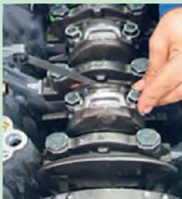
شکل ۱۰۲. کنترل لقی شاتون روی محور میل لنگ
