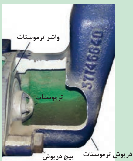
شکل ۱۷. نمای برش خورده ترموستات تراکتور MF۲۸۵
