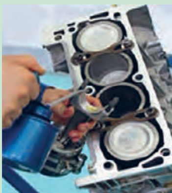
شکل ۱۰۱. روغن کاری کپه یاتاقان شاتون
