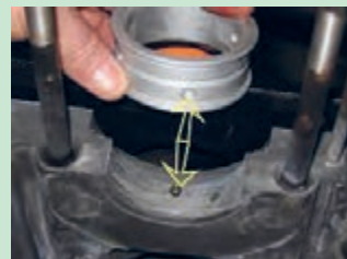
شکل ۹۳. قرار گرفتن سوراخ روغن مقابل هم
