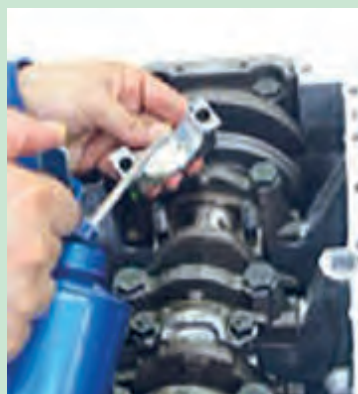
شکل ۱۰۱. روغن کاری کپه یاتاقان شاتون
