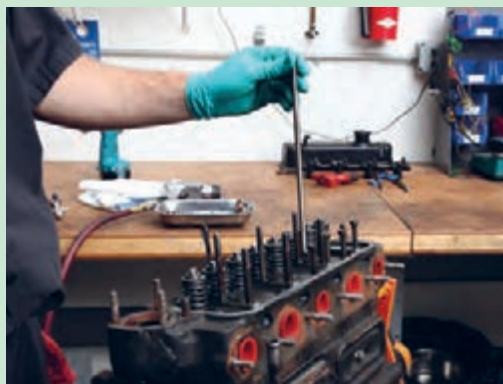
شکل ۴۷. خارج کردن میل تپت‌ها
