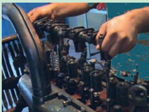
شکل ۴۶. برداشتن مجموعه اسبک از روی سرسیلندر
