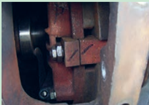
شکل ۲۶. علامتگذاری قطعات مجموعه کلاچ
