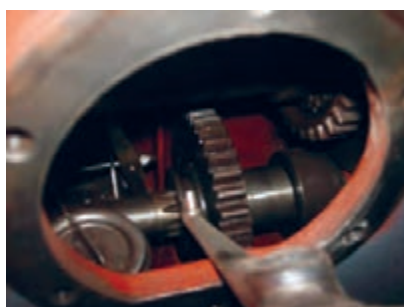
شکل ۲۱. محور تواندهی در حالت موتور گرد
