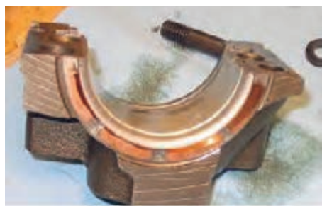
شکل ۷۳. نمونه بغل یاتاقانی معیوب
