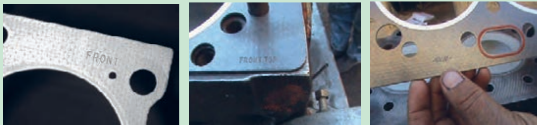
شکل ۸۶. علامت های روی واشر سرسیلندر
