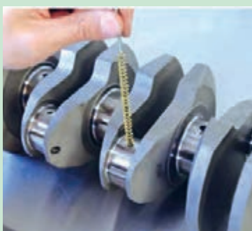
شکل ۶۰. تمیز کردن مجاری میل لنگ
