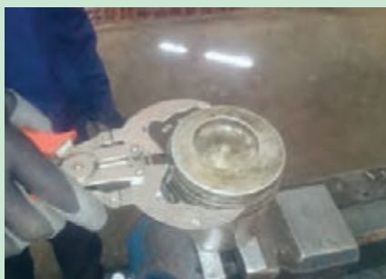
شکل ۵۲. نحوه خارج کردن رینگ از روی پیستون
