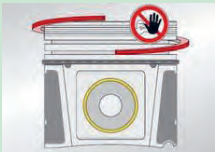
شکل ۵۳. خارج کردن رینگ بدون رینگ بازکن
