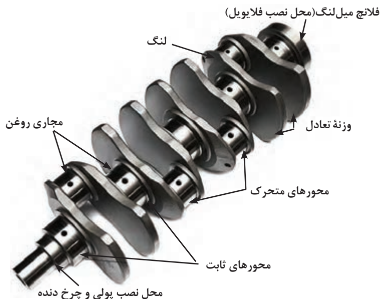
شکل ۱۶. اجزاء میل لنگ
