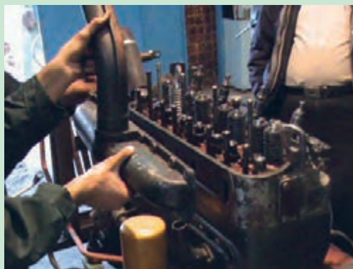
شکل ۴۳. باز کردن مانیفولد تراکتور U650
