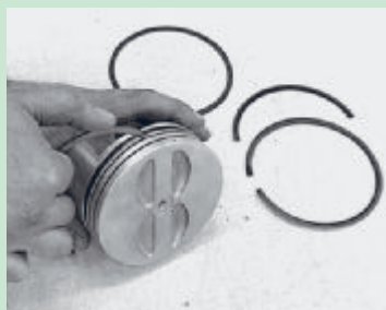
شکل ۵۸. روش های تمیز کردن شیار رینگ پیستون
