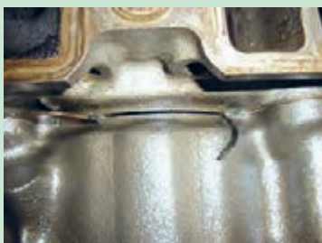
شکل ۶۲. ترک در سیلندر و بلوکه سیلندر
