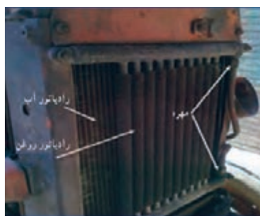
الف- عبور لوله مایع خنک‌کننده از کارتر ب- عبور مایع خنک‌کننده از پایه فیلتر JD314 ج- رادیاتور روغن U650 شکل ۴۶. انواع خنک‌کن روغن رایج در تراکتورها
