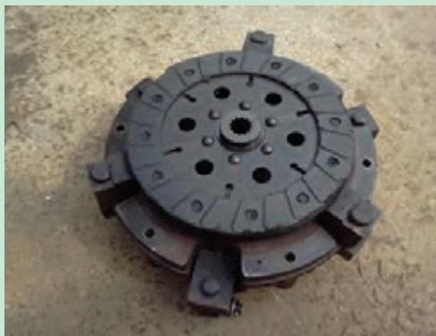
شکل ۲۵. جدا کردن مجموعه کلاچ از فلاپیول
