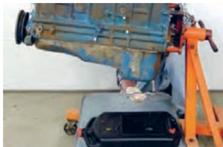
شکل ۳۳. موتور نصب شده روی استند
