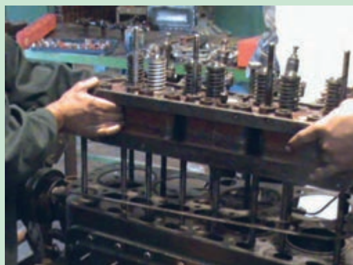
شکل ۴۸. برداشتن سرسیلندر
