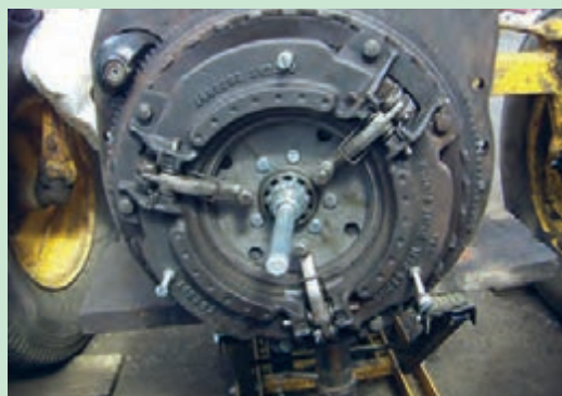
شکل ۳۷. سوار کردن مجموعه کلاچ روی فلاپیول
