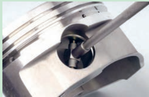
شکل ۸۱. اندازه گیری لقی گزن بین در پیستون
