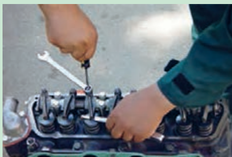
شکل ۳۶. فیلرگیری
