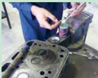
شکل ۷۸. زدن روغن سنباده به سوپاپ ها
