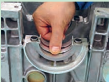
شکل ۵۰. برداشتن یاتاقان های ثابت و بغل یاتاقانی
