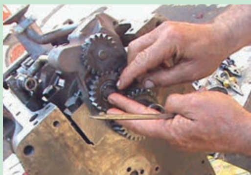
شکل ۳۸. پیاده کردن پمپ روغن
