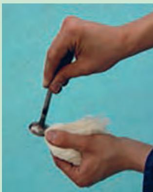
شکل ۸۰. تمیز کردن سوپاپ
