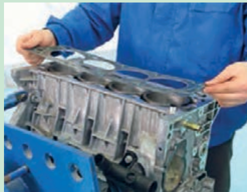
شکل ۵۰. برداشتن و اشر سر سیلندر
