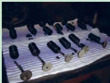
شکل ۵۹. چیدن اجزای سوپاپ به ترتیب باز شدن
