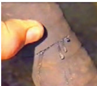
شکل ۶. نشتی از شیلنگ ها
