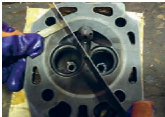
شکل ۶۵. کنترل تابیدگی سرسیلندر تراکتور دوچرخ
