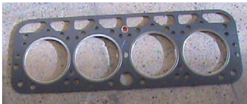
شکل ۱۳- واشر سرسیلندر تراکتور رومانی (U650)
