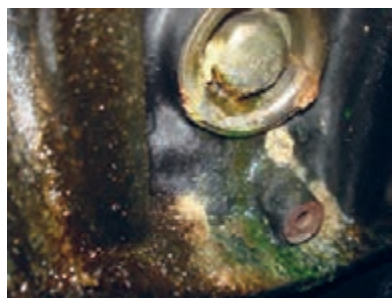
شکل ۷. نشتی از پولکی های موتور
