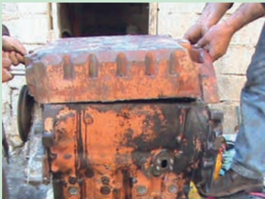
شکل ۱۱۵. نصب کارتر روی بلوکه سیلندر
