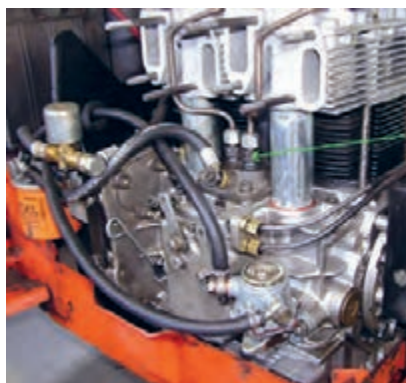
شکل ۲۷. پمپ انژکتور واحدی و موقعیت آن روی تراکتور باگی با موتور لمباردینی
