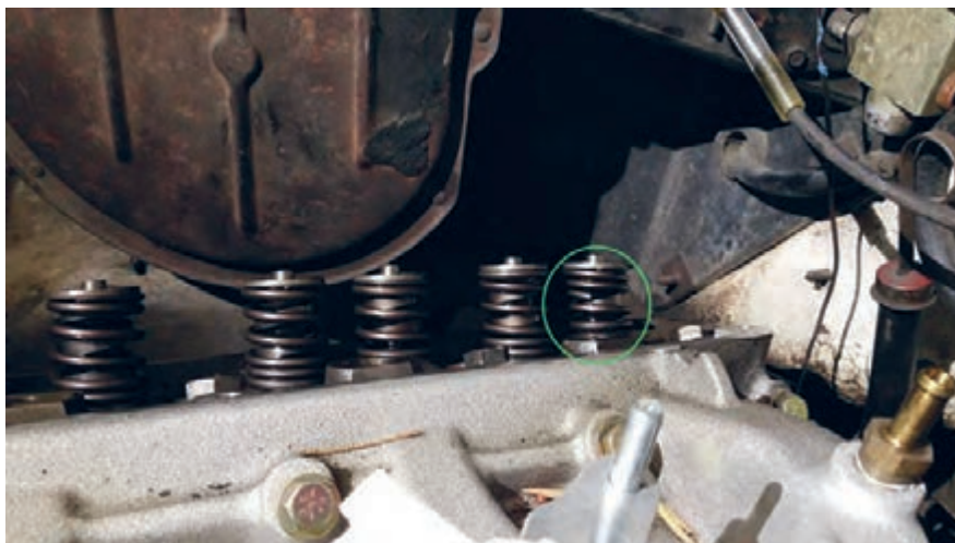
شکل ۷۱. شکستن فنر سوپاپ
