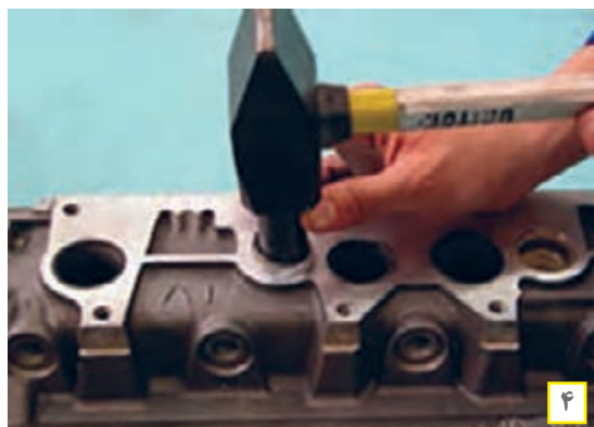
شکل ۶۹. روش تعویض پولک سر سیلندر
