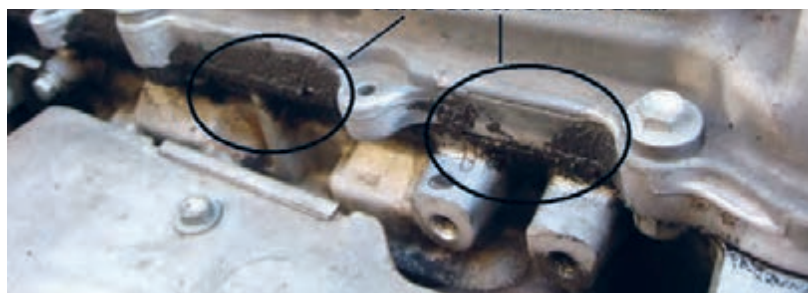
شکل ۲۷. نشتی روغن از درپوش سوپاپ‌ها
