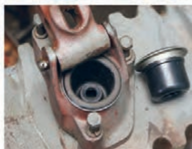
شکل ۶. مکانیزم کارانداز ترمز تراکتور MF۲۸۵
