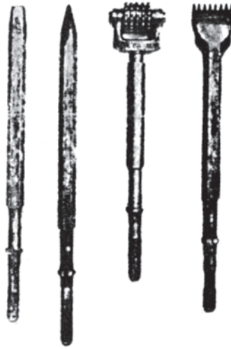
شکل ۱۶-۱۰- انواع مختلف سرچکش، نقطه‌ای کوتاه و بلند، غلتکی و شانه‌ای
