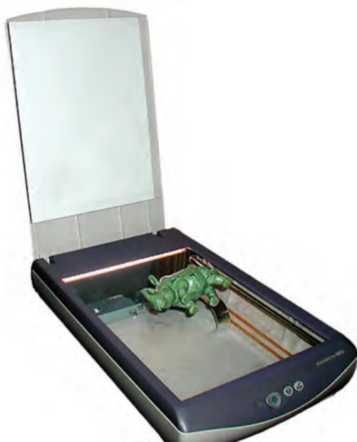
شکل ۳-۶- اسکنر تخت و شیوه اسکنوگرافی از یک مجسمه
