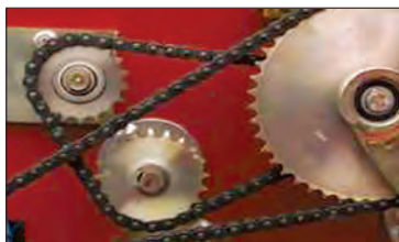
چرخ دنده ها را می توان با زنجیر هم به یکدیگر متصل کرد. در دو چرخه از این روش استفاده شده است.
