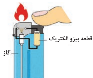
شکل ۱۲ (ج) - کاربرد پیزوالکتریک در فندک
