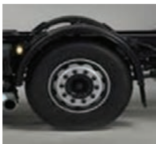
شکل ۳- موقعیت نصب گلگیر و باران گیر
