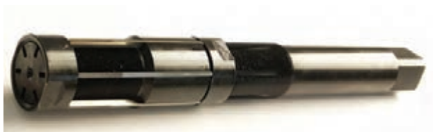
شکل ۲۰-۳- برقوی دستی شیيار مستقیم قابل تنظیم
