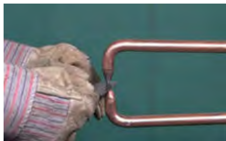
اعمال فشار الکتروودها بر روی قطعه کار
