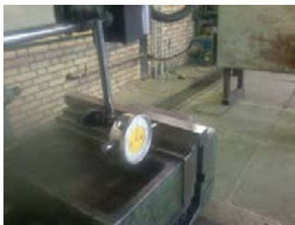
شکل ۱۹-۴- تنظیم و بستن گیره روی میز دریل
