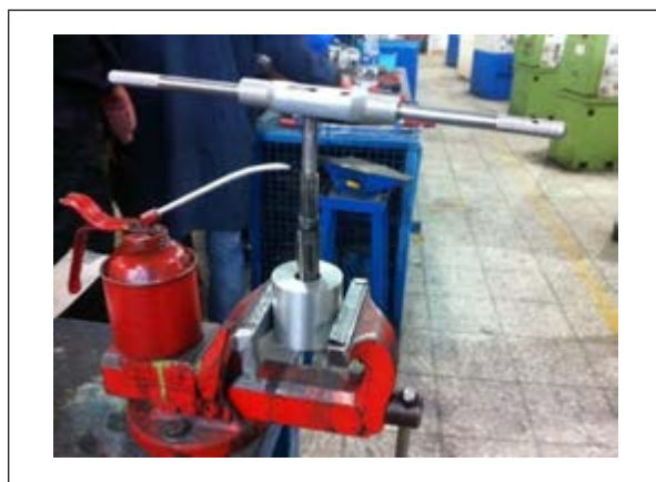
شکل ۳-۲۴- تنظیم و هدایت برقو به داخل قطعه کار
