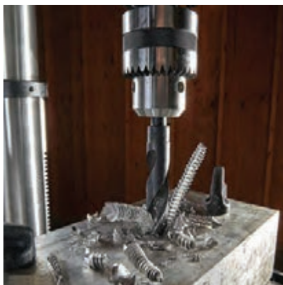
شکل ۳۰-۳- عملیات سوراخ کاری قبل از برقوکاری
