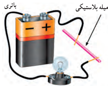
شکل ۲۰ - ۱ برقرار نشدن جریان الکتریکی در عایق
