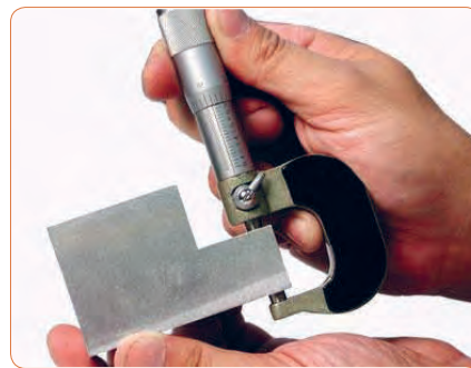
شکل ۱۶- ۲- چگونگی در دست گرفتن میکرومتر
