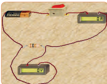
شکل ۳-۴۵ مدار با ولت متر و آمپر متر
