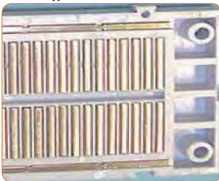
شکل ۸۹- ۱- اتصالات داخلی برد بُرد
