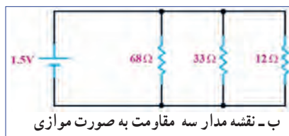
شکل ۶۶-۱ - سه مقاومت به صورت موازی
