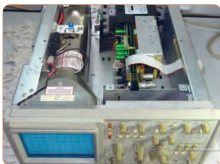
شکل ۴-۵۲- ساختمان داخلی یک نوع اسیلوسکوپ
