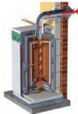
یک مبدل گاز به مایع (آب گرم‌کن زمینی)
