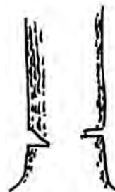
شکل ۱۶-۲- مرحله دوم، عمل برش درخت در جهتی که باید بر روی زمین بیفتد.
