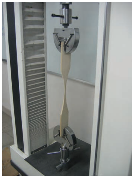
شکل ۵-۲۹- طرز قرار گرفتن نمونه آزمایش کشش چوب در گیره
