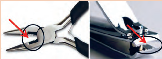
شکل ۵-۲۷- لبه های برنده خراب شده در ناخن گیر و دم باریک
