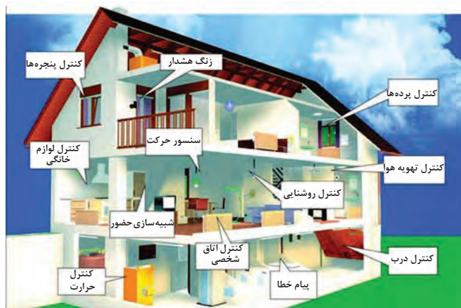
شکل ۲۱-۵- حسگرهای استفاده شده در یک خانه هوشمند
