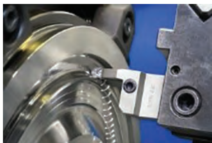
شکل ۶-۴: براده‌برداری به‌وسیله تیغه کاربیدی
