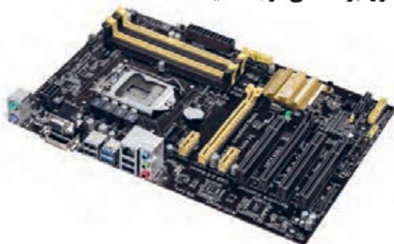
شکل ۸ - برد اصلی با فرم فاکتور ATX
