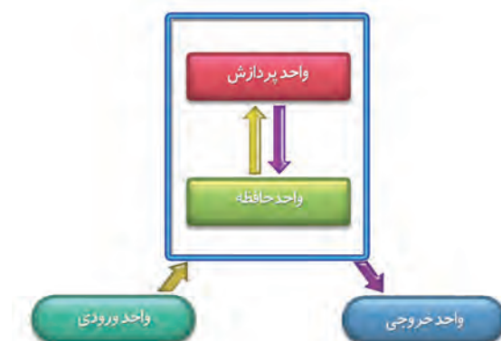
شکل ۱- نمودار سخت‌افزاری سیستم رایانه‌ای
