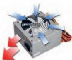
شکل ۲۳- جهت تهویه هوا در منبع تغذیه
