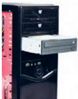
شکل ۵۰- قراردادن دیسک گردان نوری در کیس
