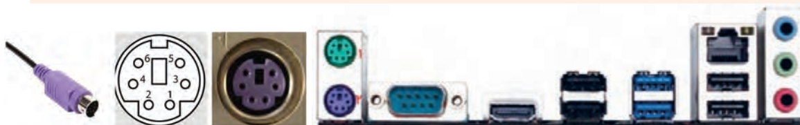
شکل ۸- درگاه‌های روی برد اصلی
