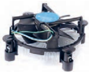
شکل ۳۶ - سیستم خنک کننده پردازنده
