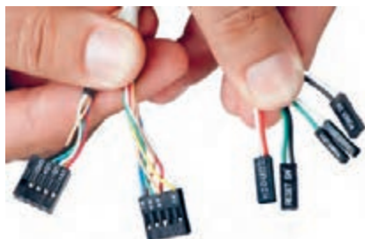
شکل ۴۴ - کانکتورهای پنل جلوی کیس
